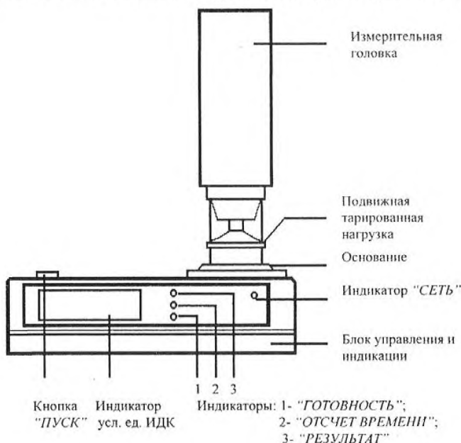
Рисунок В. 1 – Общая схема прибора для определения качества клейковины ИДК
