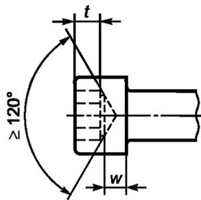
Для прошитых углублений наибольший предельный размер расширения в результате сверления не должен превышать 1/3 длины любой грани углубления, равной  $e/2$
