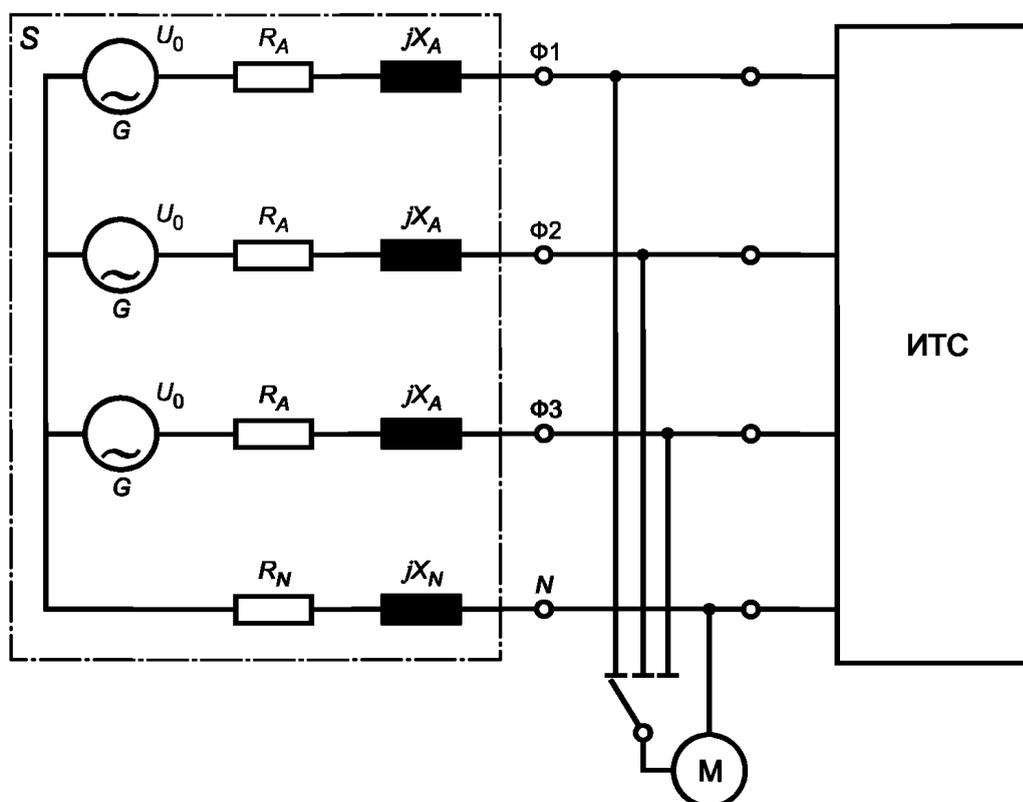
а) при испытаниях в соответствии с 6.1 и 6.2 и применении испытательного полного сопротивления  $Z_{test}$  равного  $Z_{ref}$ :
