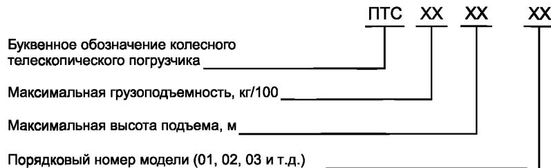
Пример условного обозначения погрузчика с телескопической стрелой с грузоподъемностью 2,5 т, высотой подъема 7 м, третьей модели:
