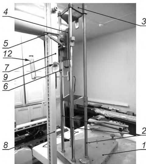
Рисунок Б.1 — Внешний вид УПС с нивелирной рейкой
