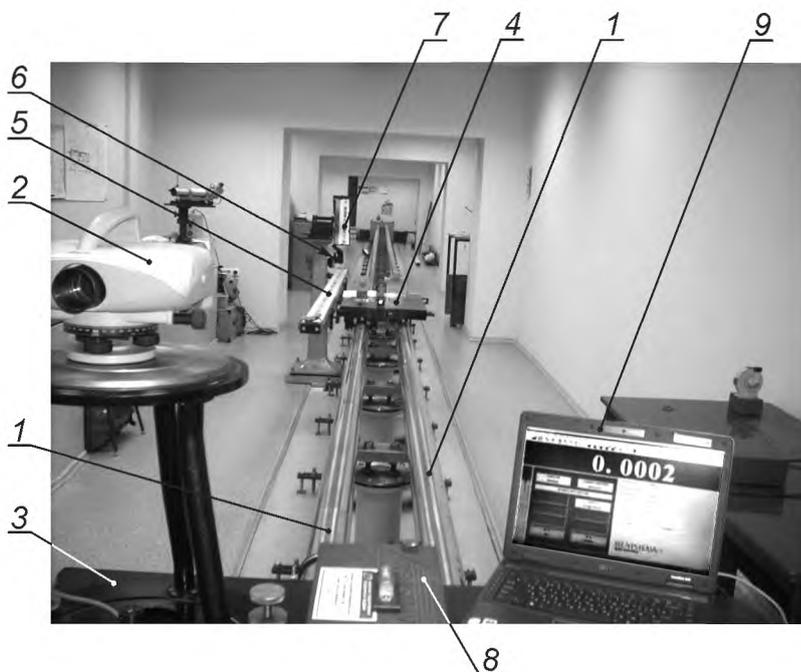
1 — направляющие лазерного интерференционного компаратора; 2 — цифровой нивелир Leica DNA-03; 3 — подставка; 4 — каретка с ложементом и уголковым отражателем с мишенью; 5 — кодовая рейка Leica GPSL 3; 6 — микроскоп; 7 — зеркало; 8 — лазерный интерферометр модели ML10 GOLD фирмы RENISHAW; 9 — набор интерфейсов DX 10 USB с ноутбуком
