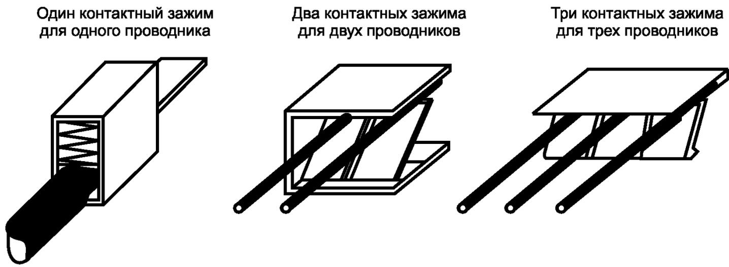
Рисунок F.6 — Примеры безвинтовых контактных зажимов
