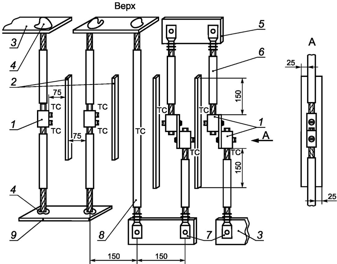
1 — испытуемый образец; 2 — теплозащитные экраны; 3 — токопроводящий проводник; 4 — сварка;
