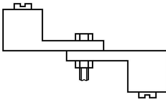
П р и м е ч а н и е — Токопроводящую деталь присоединяют болтами, пайкой или сваркой.
