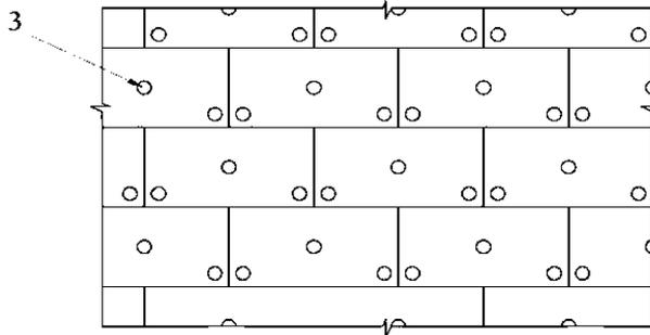
Схема установки ветрогидрозащитной мембраны.
