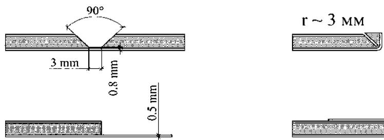
Рисунок 6 – Виды фрезеровок
