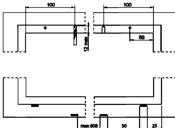
Рисунок Г.9 – Схема расположения водосливных отверстий
