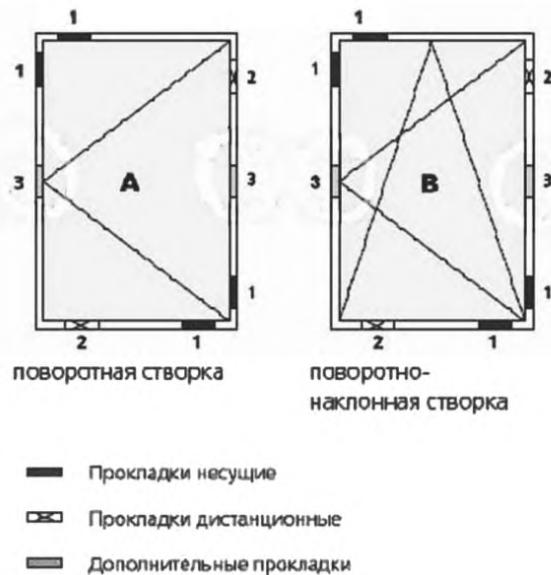
Рисунок Г.10 – Схема расположения установочных прокладок
