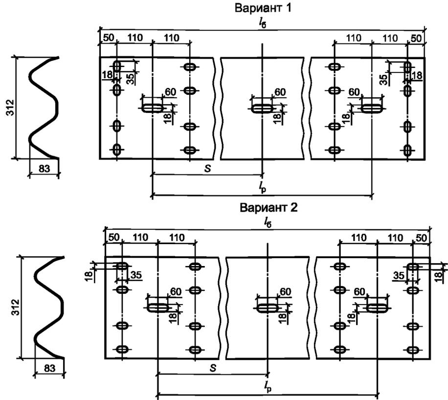
$l_b$  — полная длина секции балки;  $l_p$  — расчетная длина секции балки;  $s$  — шаг осевых отверстий
