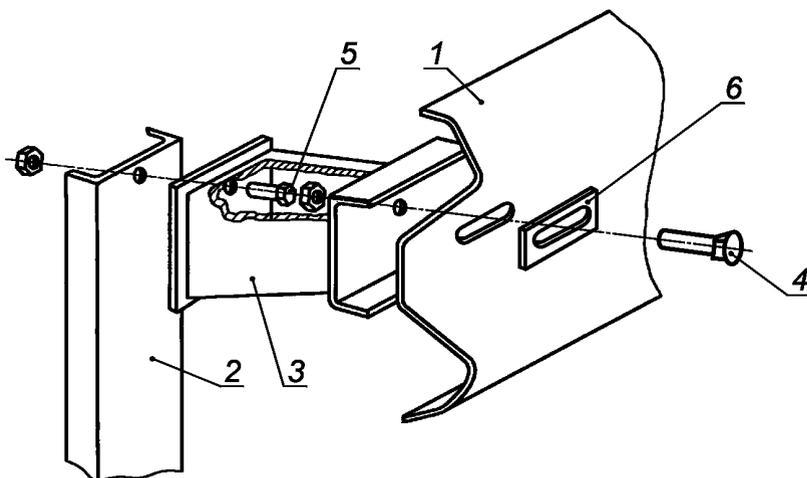
1 — балка; 2 — стойка; 3 — консоль жесткая, 4 — болт M16 × 45.5.8; 5 — болт M16 × 30.5.8;
