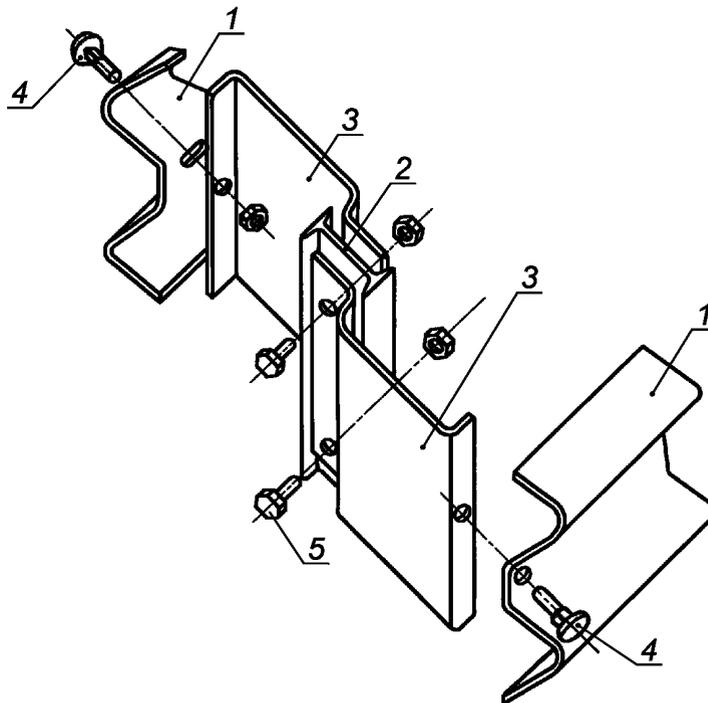
1 — балка; 2 — стойка; 3 — консоль-амортизатор; 4 — болт M16 × 45.5.8; 5 — болт M16 × 30.5.8
