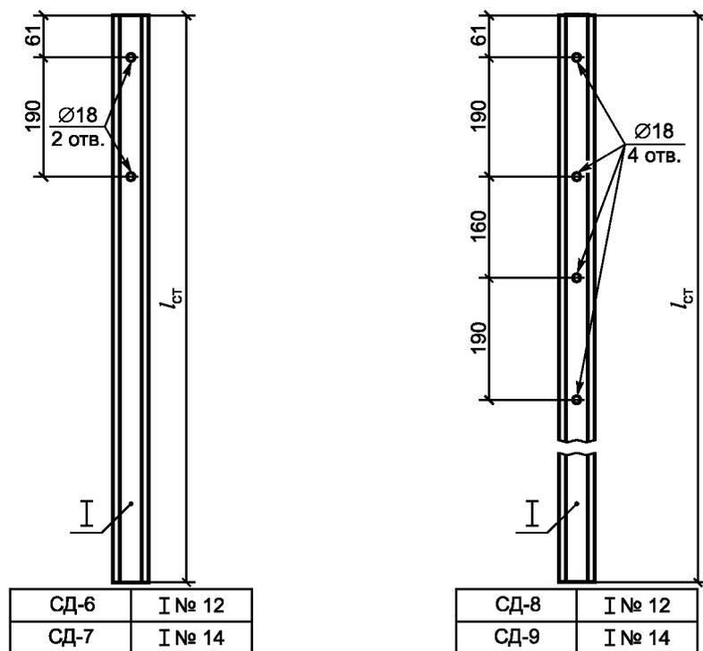
г) Для односторонних ограждений с консолью-амортизатором с одним ярусом балки
