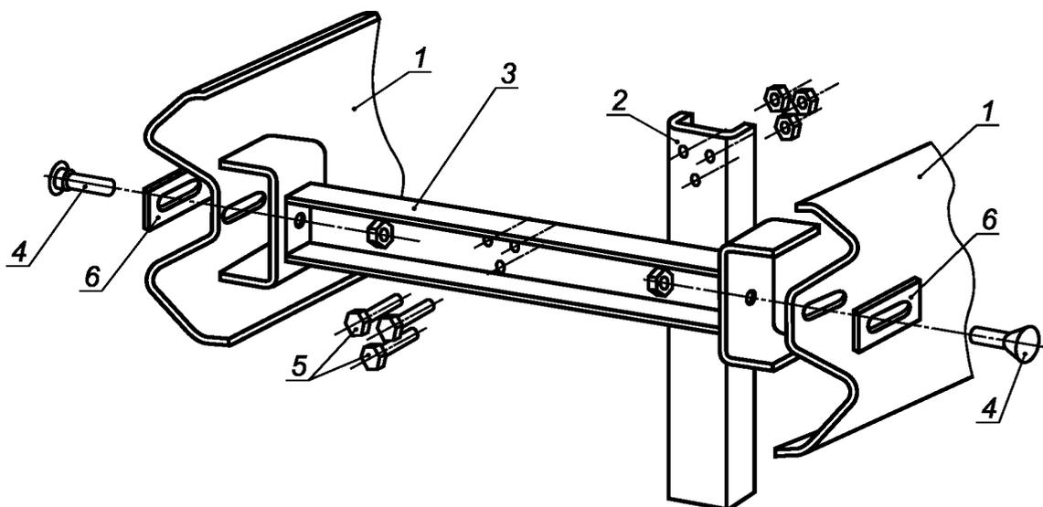
1 — балка; 2 — стойка; 3 — консоль-распорка; 4 — болт M16 × 45.5.8; 5 — болт M16 × 30.5.8;
