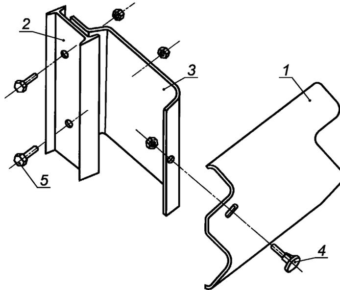
1 — балка; 2 — стойка; 3 — консоль-амортизатор; 4 — болт M16 × 45.5.8; 5 — болт M16 × 30.5.8
