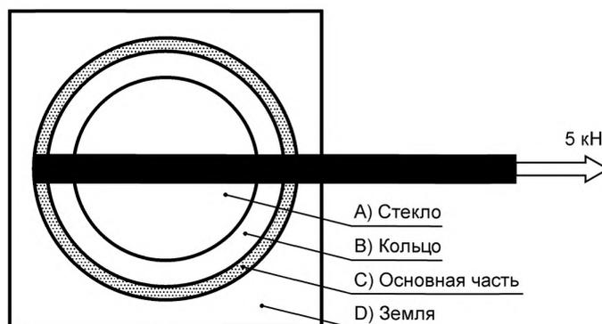
Сила, прилагаемая к брусу, составляет + 5 кН, испытание повторяют 20 раз.
