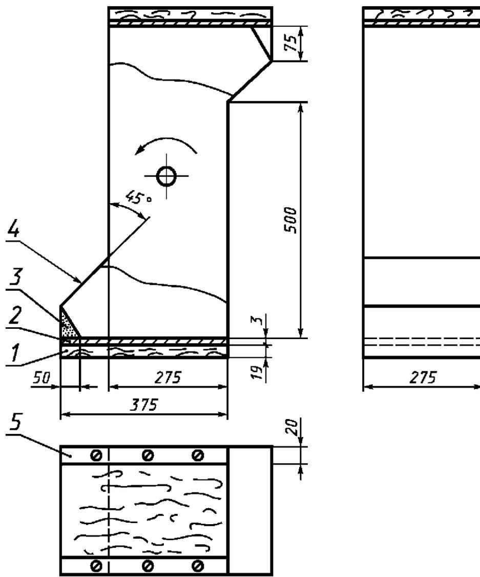
1 — деревянная доска; 2 — стальная плита; 3 — резиновая пластина; 4 — лист слоистого пластика; 5 — крепление дна
