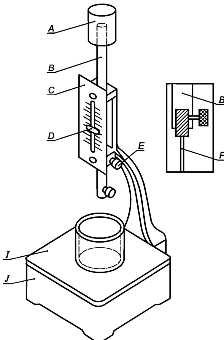
*A* — дополнительная нагрузка; *B* — стержень длиной  $(270 \pm 5)$  мм и диаметром  $(10 \pm 1)$  мм; *C* — измерительная шкала, мм; *D* — указатель; *E* — винтовой зажим; *F* — игла Вика длиной  $(50 \pm 1)$  мм с поперечным сечением и диаметром  $(1 \pm 0,05)$  мм; *I* — стеклянная пластина размером  $(100 \times 100)$  мм; *J* — поддерживающая опора.
