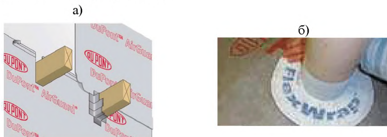
Рисунок П.7 – Герметизация мест примыкания пароизоляции AirGuard® Sd5 к выступающим элементам лентой Tyvek® FlexWrap
