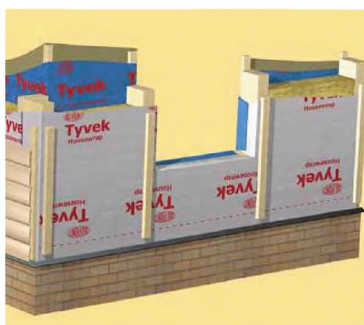
Рисунок П.3 – Монтаж контрорешетки по мембране Tyvek®
