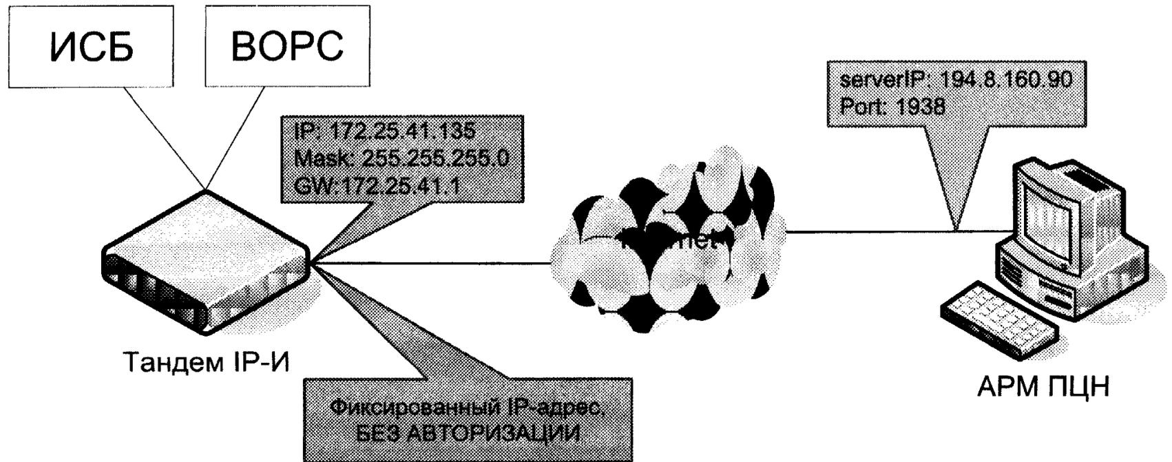
*Рисунок В.6 - Прямое подключение прибора к Интернету с использованием фиксированного IP-адреса и без авторизации*
