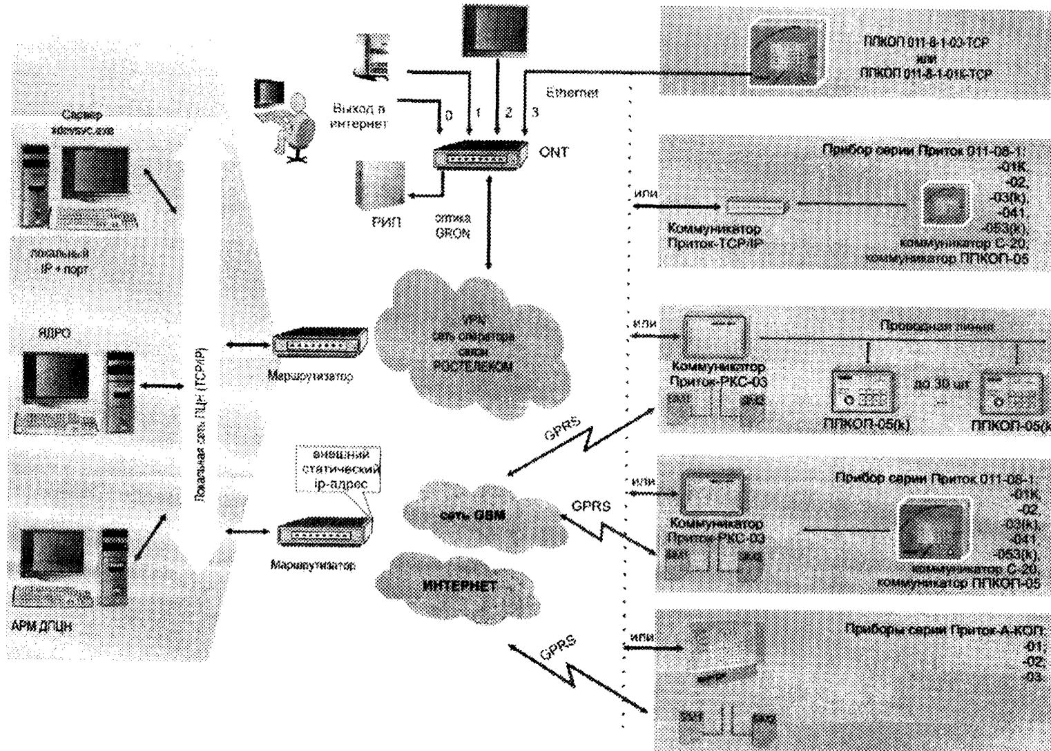
Рисунок Б.2 - Организация централизованной охраны с использованием технологии GPON
