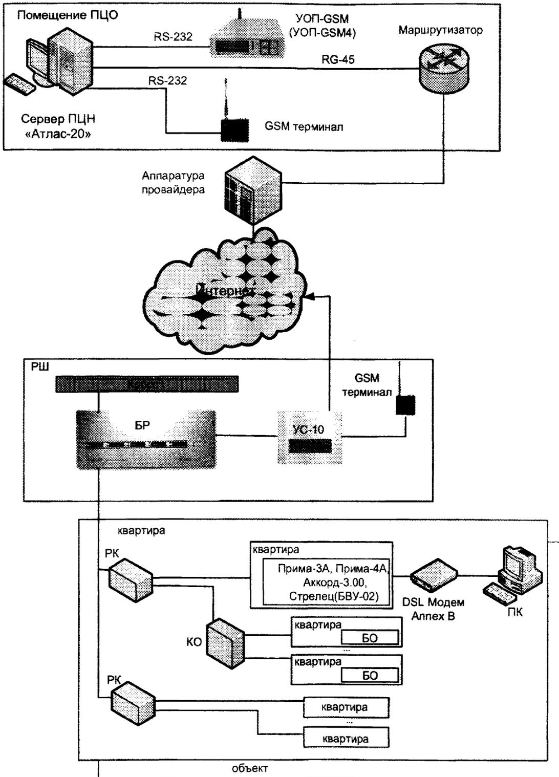
*Рисунок В.2 - Установка ретрансляторов «малой» емкости при использовании технологии FTTH*
