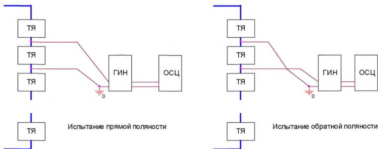
Рис. А.1. Схема испытаний ячейки ВТВ от ГИН.
