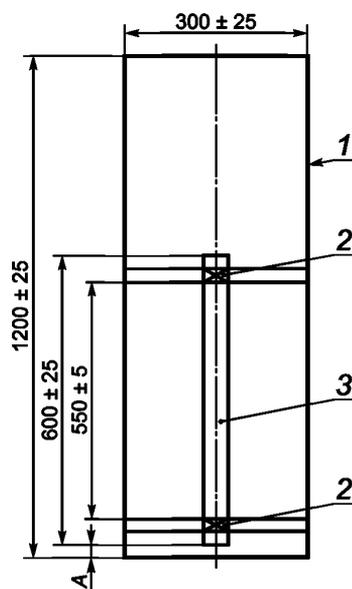
1 — металлическая камера; 2 — опорный стержень и крепление медной проволокой; 3 — образец;
