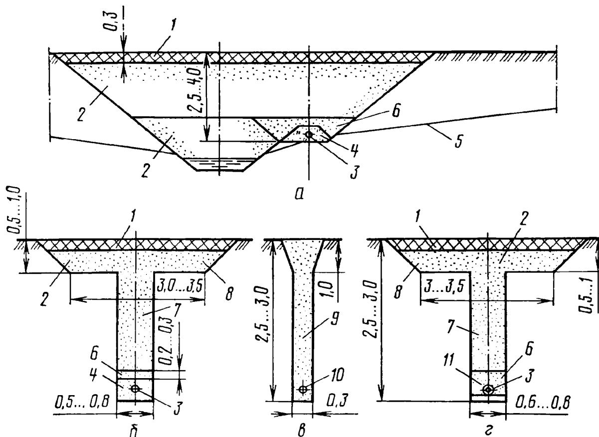
*α – закрытой, устраиваемой методом «полки» (в водонасыщенных грунтах); β – закрытой с песчано-гравийным фильтром; γ – бестраншейной пластмассовой; γ – закрытой с минерально-волокнистым фильтром;*
