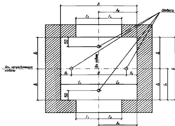
А, А1, Б, Б1, В – размеры, определяемые монтажным (установочным) чертежом.
