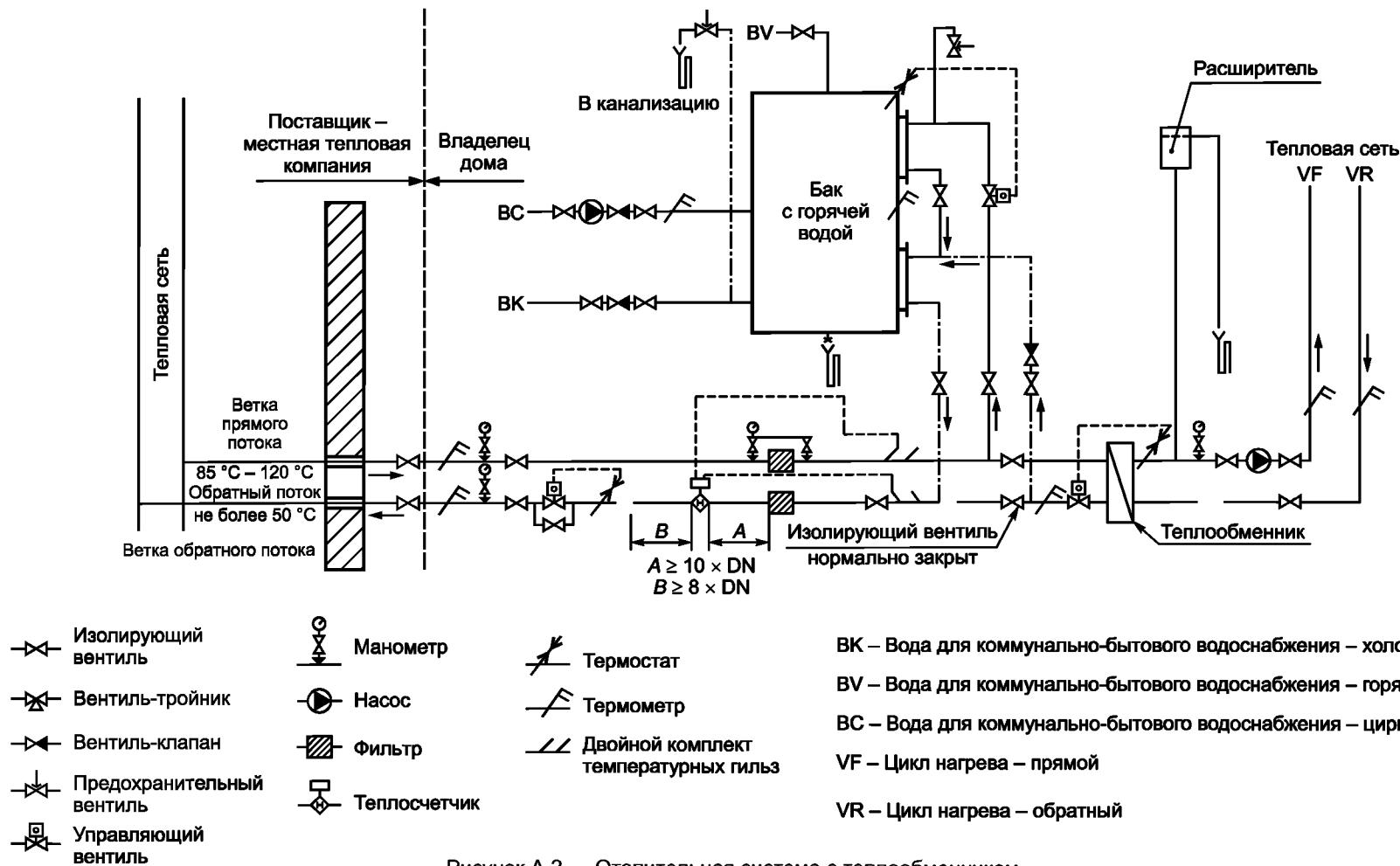
Рисунок А.2 — Отопительная система с теплообменником
