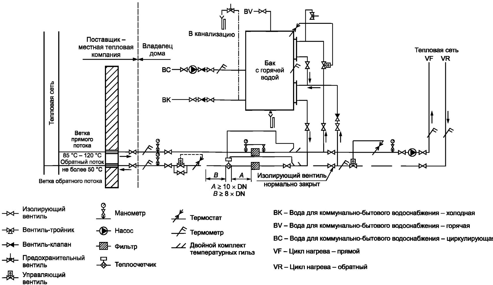
Рисунок А.3 — Отопительная система — прямой тип
