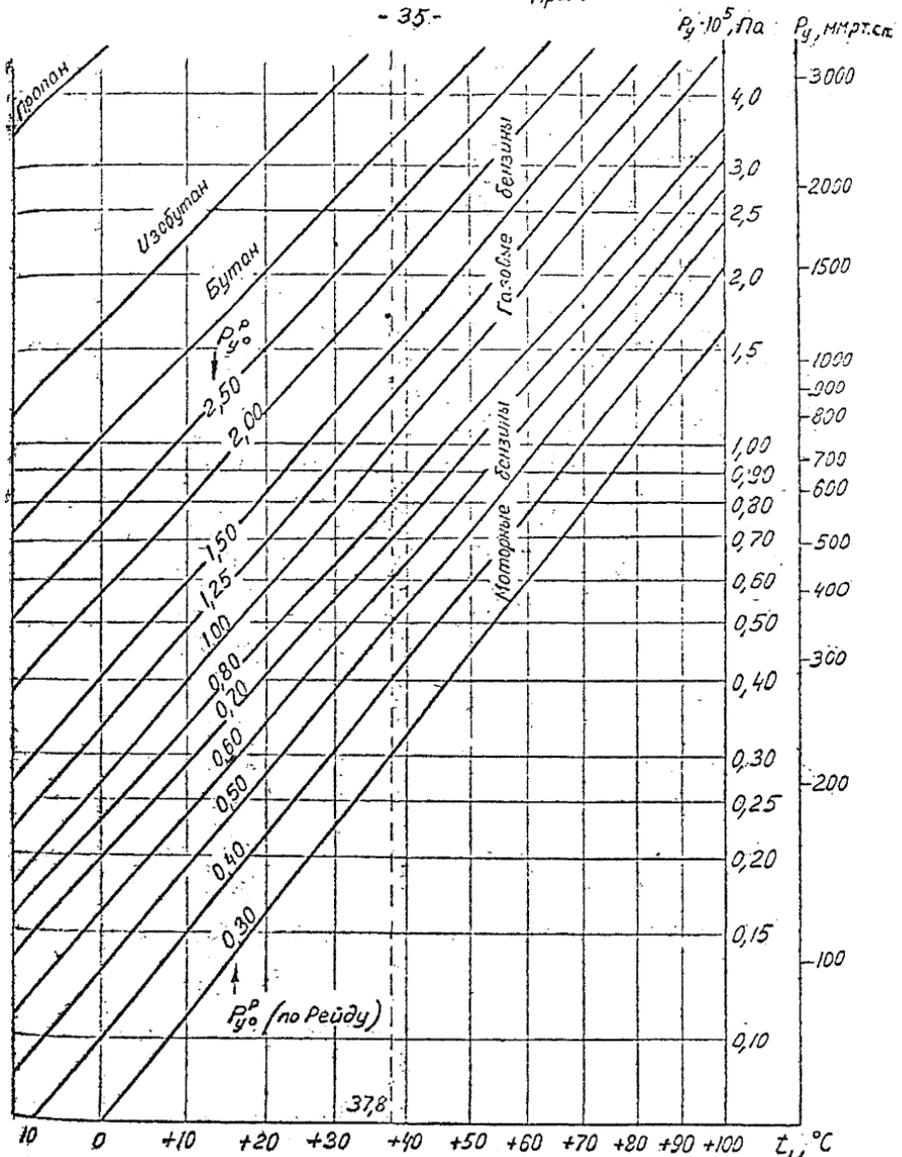
График зависимости давления насыщенных паров бензинов от температуры.
