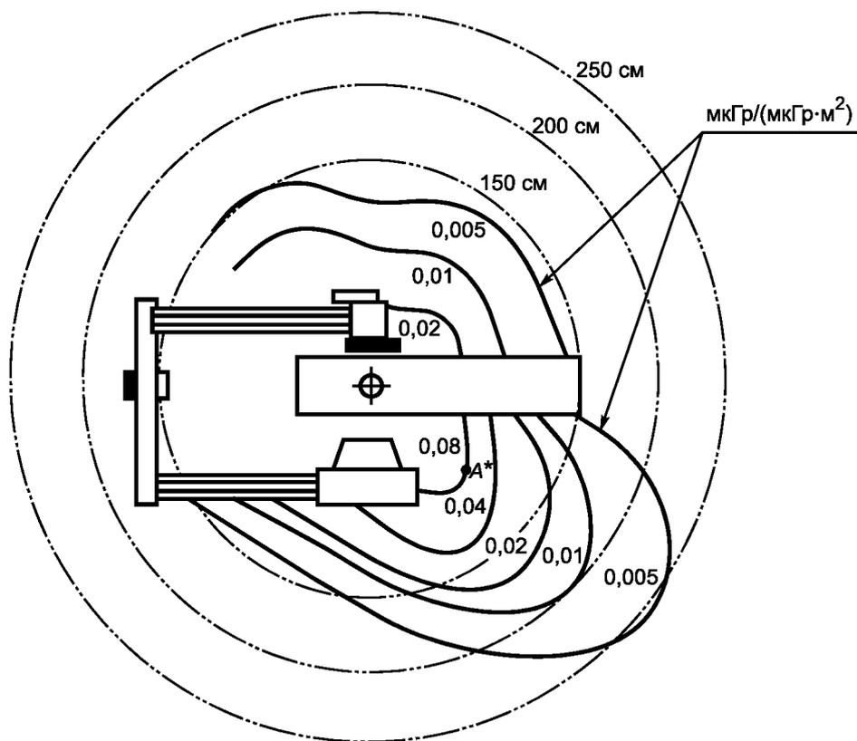
\* Пример определения дозы неиспользуемого излучения в месте расположения персонала (точка А): за время проведения исследований встроенный в аппарат измеритель ПРОИЗВЕДЕНИЯ ДОЗА × ПЛОЩАДЬ показал суммарное значение, например  $100 \text{ мкГр} \cdot \text{м}^2$ . Тогда значение суммарной дозы неиспользуемого излучения в точке А составит  $8 \text{ мкГр}$ .
