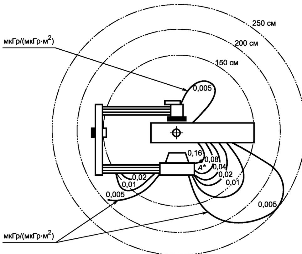
\* Пример определения дозы неиспользуемого излучения в месте расположения персонала (точка А): за время проведения исследований встроенный в аппарат измеритель ПРОИЗВЕДЕНИЯ ДОЗА × ПЛОЩАДЬ показал суммарное значение, например  $100 \text{ мкГр} \cdot \text{м}^2$ . Тогда значение суммарной дозы неиспользуемого излучения в точке А составит  $16 \text{ мкГр}$ .
