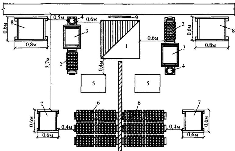
Рис. 2.2. Схема организации рабочего места при кладке печи в перегородке:
