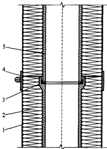
Рис. 6.9. Деталь соединительного стыка дымовой трубы:
