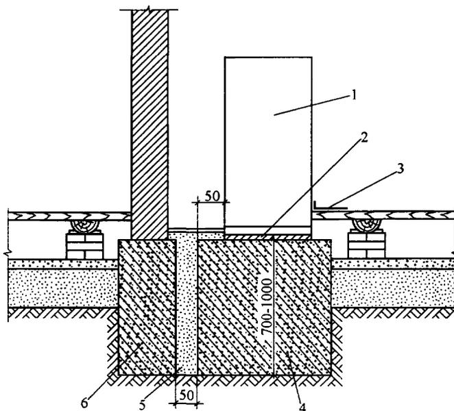
Рис. 3.4. Размещение печи на отдельном фундаменте:
