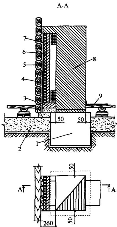
Рис. 3.8. Устройство закрытой отступки:
