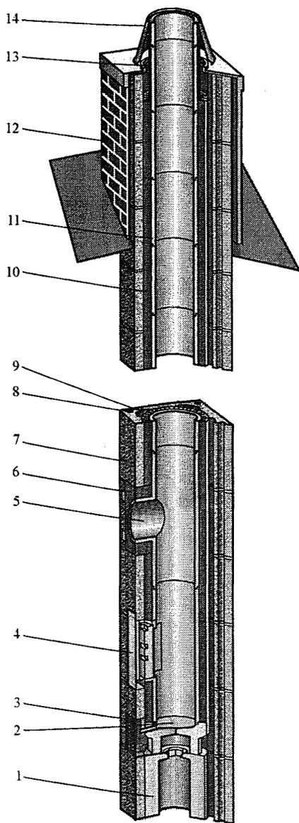
6.4.3. Перед началом монтажа следует определить место расположения дверок для ревизии и чистки трубы, а также место расположения и высоту подключения теплогенерирующей установки.
