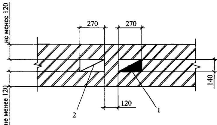
Рис. 6.1. Размещение каналов во внутренней стене:
