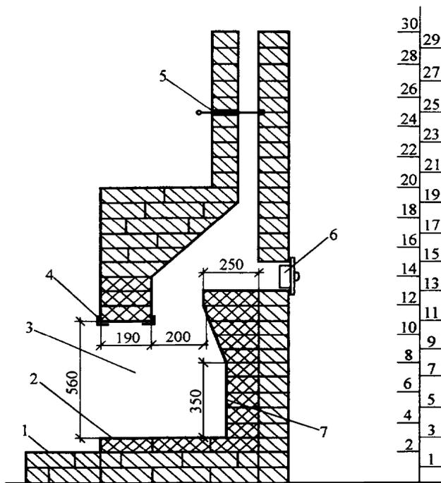
Рис. 5.1. Устройство камина из кирпича:
