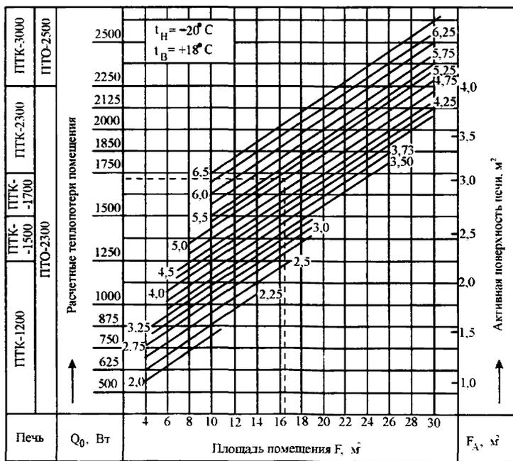
Рис. 3.1. Номограмма для определения теплотер неугловых комнат
