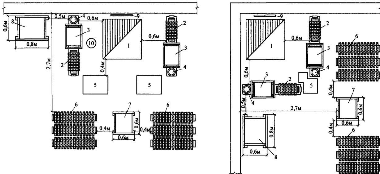
Рис. 2.1. Схема организации рабочего места при кладке печи у стены и в углу помещения:
