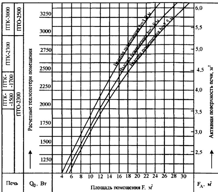
Рис. 3.2. Номограмма для определения теплотерь угловых комнат
