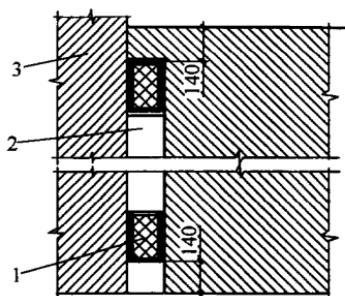
Рис. 3.7. Схема размещения вентиляционных решеток:
