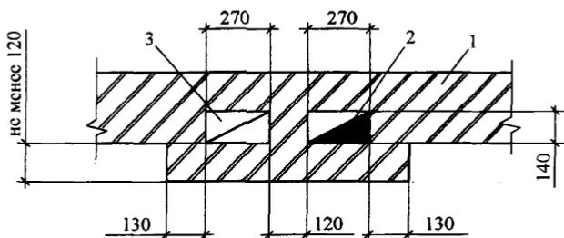
Рис. 6.3. Размещение каналов в наружной кирпичной стене:
