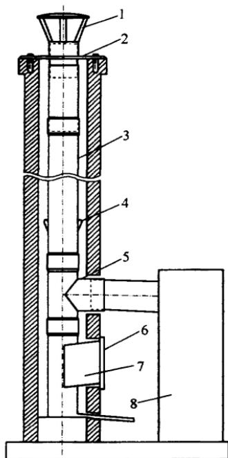
Рис. 6.6. Прокладка трубы в кирпичном канале:
