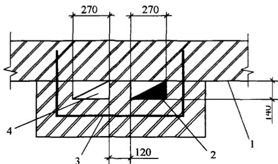
Рис. 6.4. Пристроенные каналы к наружной кирпичной стене:
