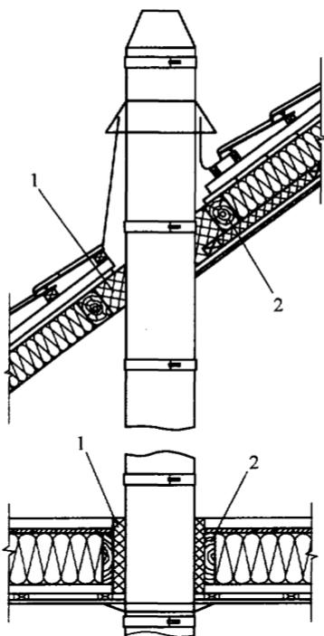
Рис. 6.14. Схема противопожарной разделки:
