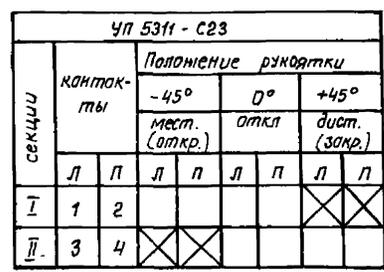
Диграмма замыкания контактов регулятора температуры SK
