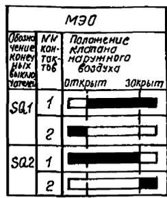
Диграмма замыкания контактов ключа управления SA1 (SA2)
