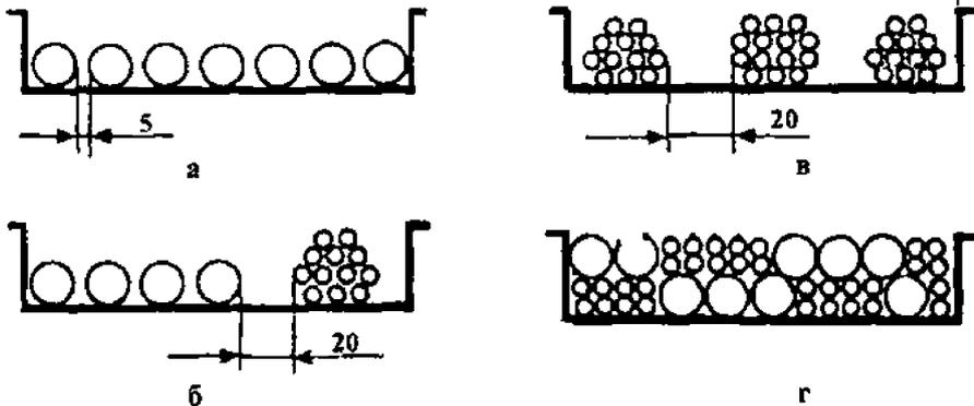
Рис.2. Способы прокладки проводов и кабелей на лотках:
