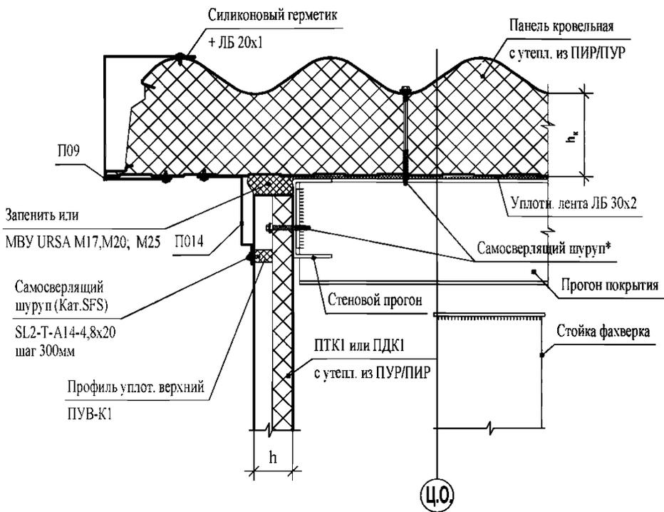
Рисунок 71 – Карнизное сопряжение ПТК1 или ПДК1 с кровельными панелями
