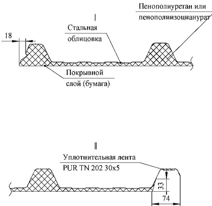
Рисунок 6 – Панель двухслойная кровельная тип 2 (ПДК Б (А, В) 2 ПИР, ПДК Б (А,В) 2 ПУР)
