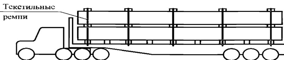
Рисунок 8 – Схема увязки панелей на автомобиле
