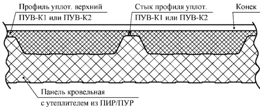
Рисунок 72 – Установка профиля уплотнительного под конек
