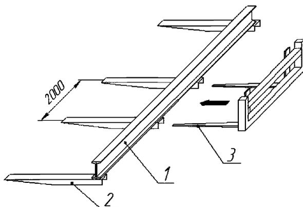
1- Двутавровая балка; 2- Швеллер; 3- Типовые "вилы" погрузчика.
