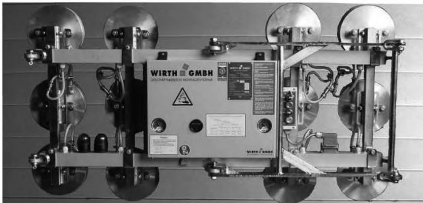
Рисунок 16– Транспортирование и укладка стеновых панелей на месте монтажа с помощью установочной системы Oktopus KT-B.
