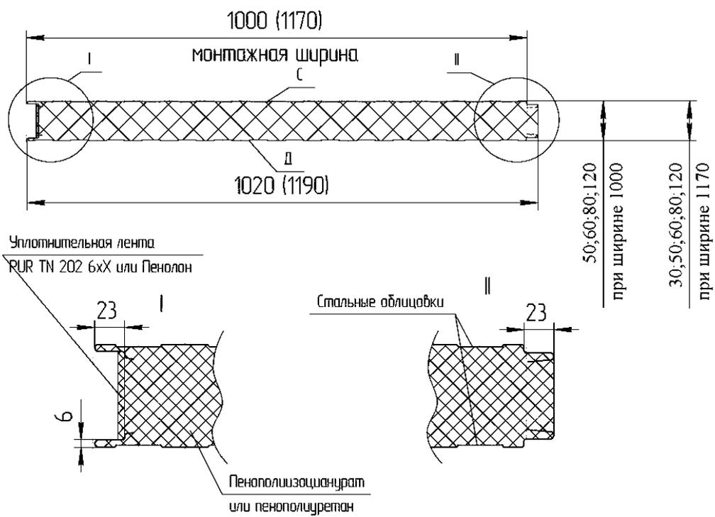
Рисунок 2 – Панель трехслойная стенная (тип 2) (ПТС 2 ПИР, ПТС 2 ПУР)
