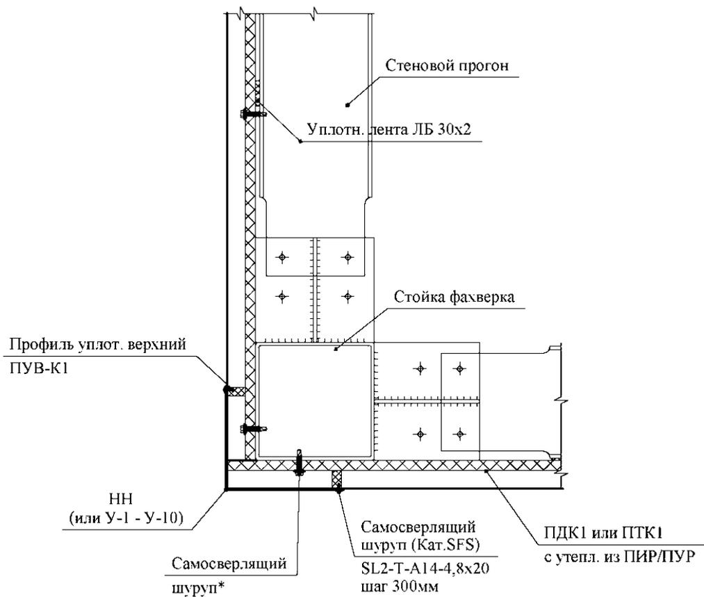
Рисунок 68 – Наружный угол стены (горизонтальная раскладка)
