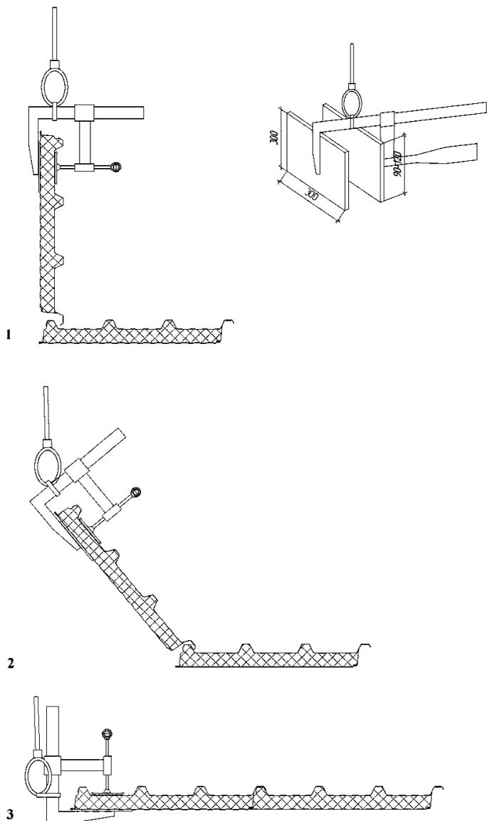
Рисунок 14 – Транспортирование и укладка кровельных панелей на месте монтажа
