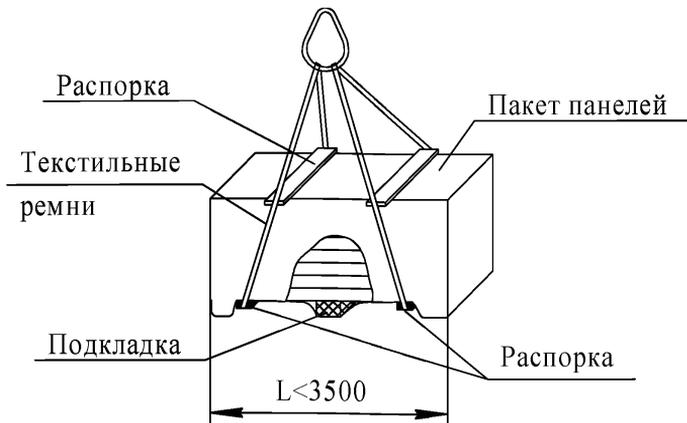
Рисунок 9 – Схема строповки пакетов панелей длиной менее 3500мм
