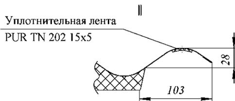
Рисунок 5 – Панель двухслейная кровельная тип 1 (ПДК Б (А,В) I ПИР, ПДК Б (А, В) I ПУР)
