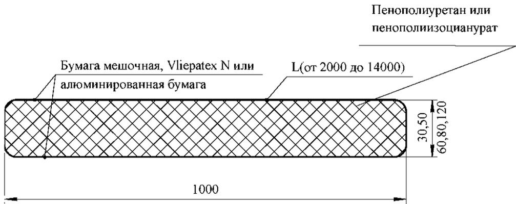
Рисунок 6а – Панель теплоизоляционная ПТБ (А, В) 1 ПИР, ПТБ(А, В) 2 ПУР
