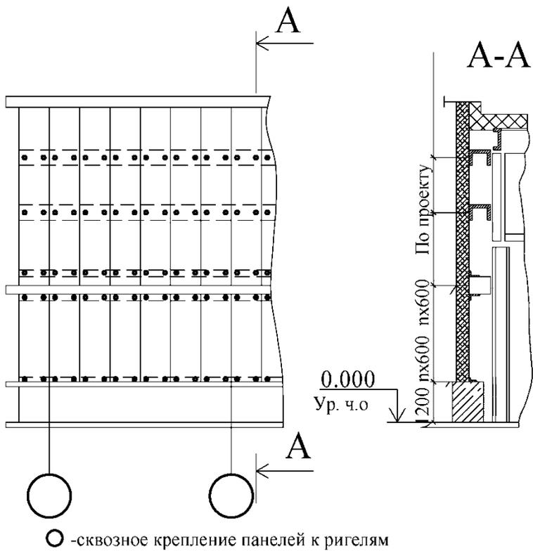
Рисунок 73 - Схема крепления стеновых панелей к ригелям
