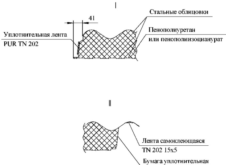
Рисунок 3—Панель трехслойная кровельная с монтажной шириной 1000 (тип 1)
