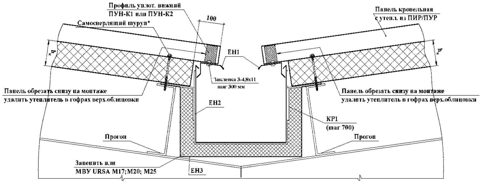
Рисунок 58 – Внутренний водослив с желобом (стык двух кровель)
