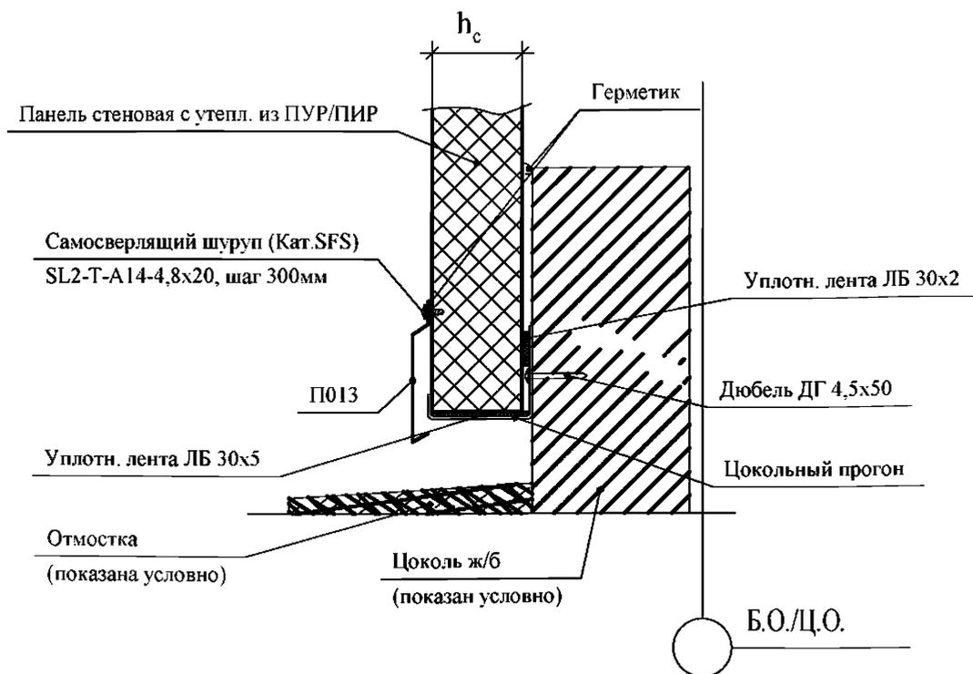
Рисунок 37 - Опираение стеновых панелей, примыкающих к цоколю (навеска)
