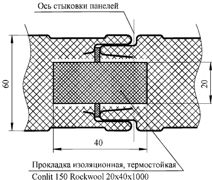
Рисунок 7 – Укладка термостойкой прокладки в стык стеновых панелей
