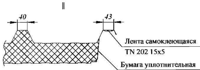
Рисунок 4 – Панель трехслойная кровельная (тип 2) - ПТК2ПИР, ПТК2ПУР
