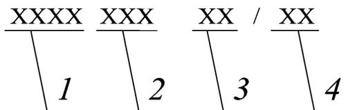
1 - Панель трёхслойная стеновая типа 1 или 2 с утеплителем из пенополиуретана (ПТС1 ПУР), (ПТС2 ПУР) или (ПТС1А ПУР), (ПТС 2А ПУР), (ПТС1Н ПУР), (ПТС2Н ПУР) или пенополиизоцианурата (ПТС1 ПИР), (ПТС2 ПИР) или (ПТС1А ПИР), (ПТС 2А ПИР), (ПТС1Н ПИР), (ПТС2Н ПИР), где «А» или «Н» означает, что одна из облицовок изготовлена из алюминиевого сплава или из нержавеющей стали;
