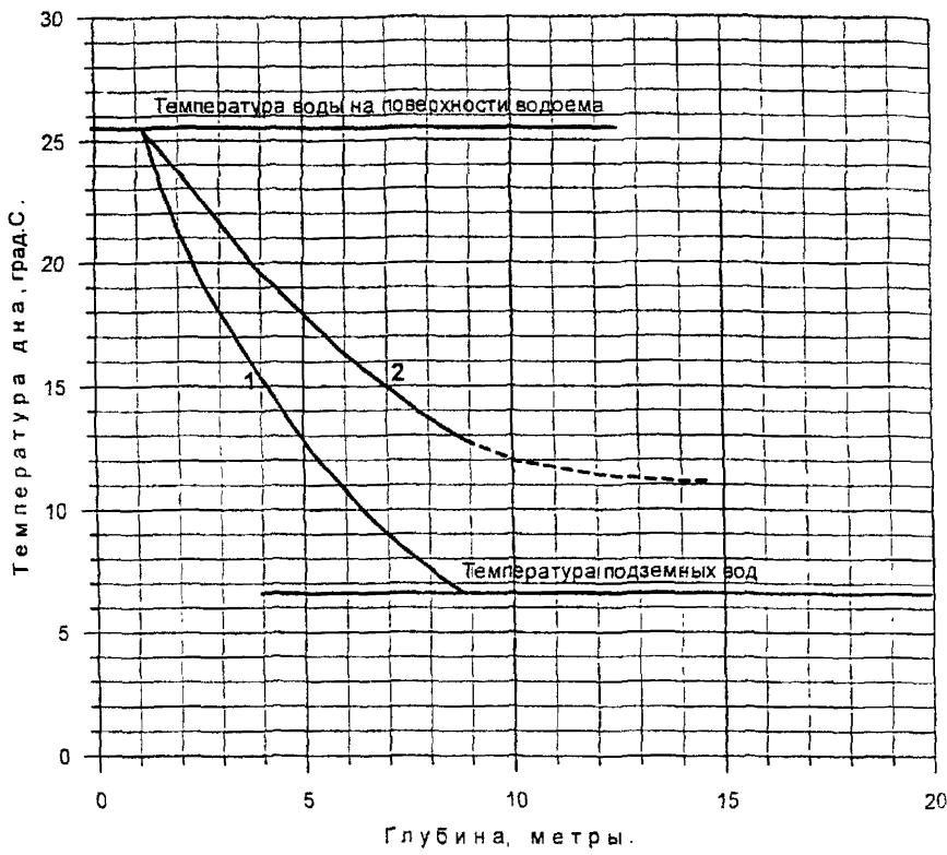
Рис. 4.3. Типовые графики изменения температуры придонного слоя воды в зависимости от глубины по закрытым и полузакрытым водоемам (1 - для участков субаквальной разгрузки, 2 - для участков инфильтрации или отсутствия заметного взаимодействия поверхностных и подземных вод).
