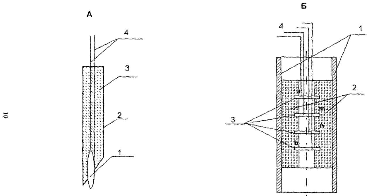
Рис. 3.1. Схематические конструкции датчиков для термометрии и резистивиметрии. А - датчик температуры (1 - термистор в металлическом корпусе, предохранительный корпус из металла, герметик, провода). Б - резистивиметр (1 - металлический корпус - экран, 2 - цилиндр из диэлектрика, 3 - электроды: "а" и "б" - токовые, "м" и "н" - измерительные, 4 - провода).
