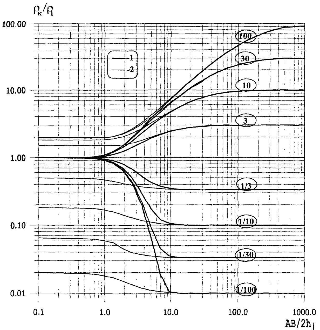
**Рис. 3.3. Двуслойные кривые ВЭЗ для поверхностной и донной установок.**
