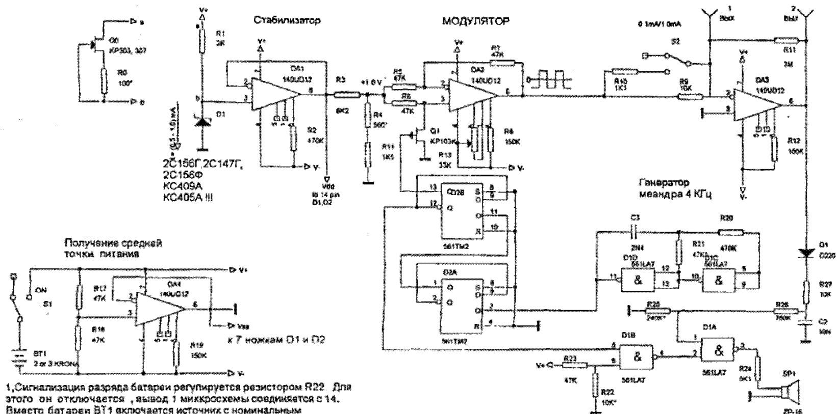
1. Сигнализация разряда батареи регулируется резистором R22. Для этого он отключается, вывод 1 микросхемы соединяется с 14. Вместо батареи BT1 включается источник с номинальным напряжением. При этом из лазеро-излучателя слышен 1 кгц тон. Устанавливаем минимальное напряжение питания и подбором резистора R22 добиваемся пропадания сигнала. Убираем перемычку между 1 и 14 ножками.
