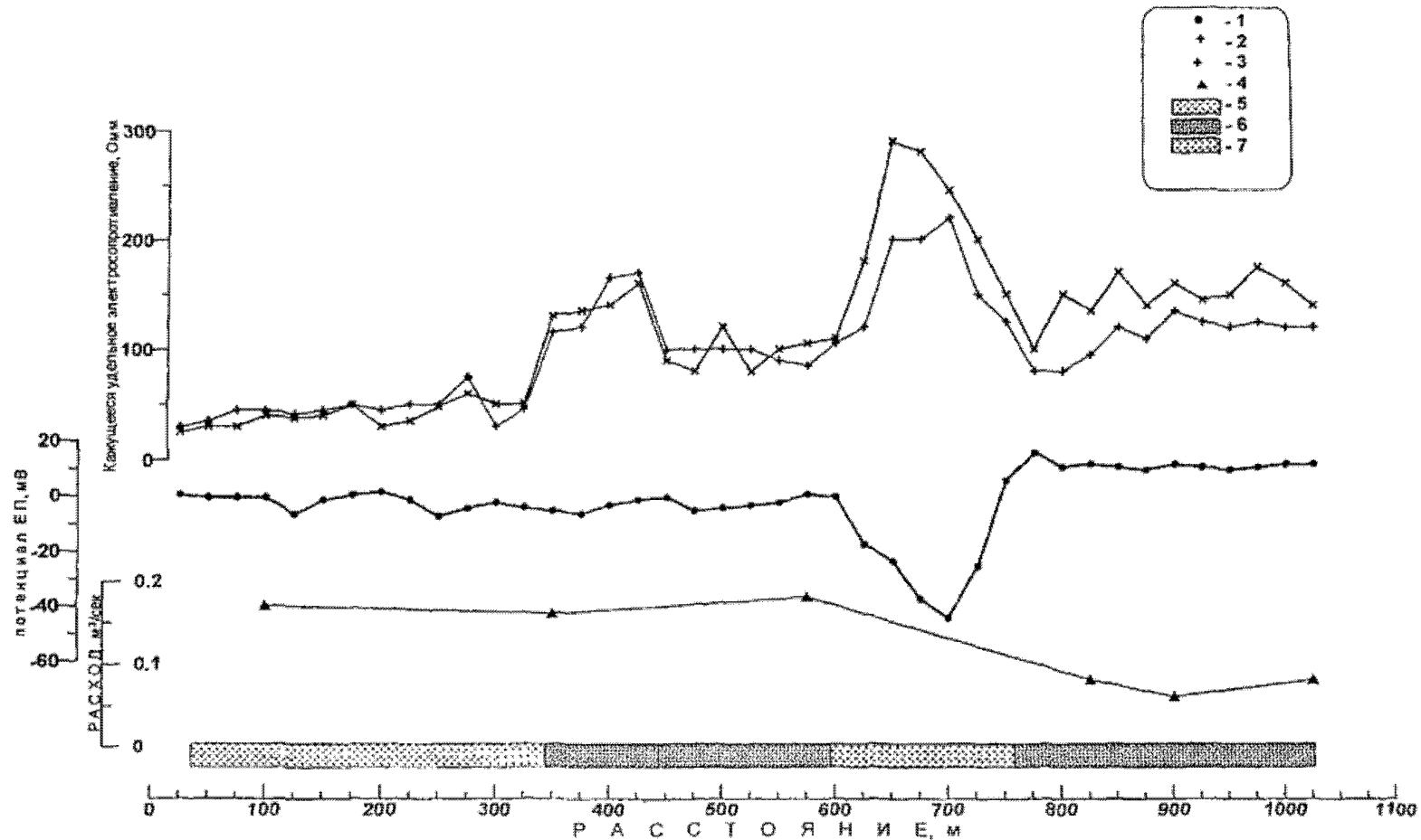
Рис. 4.9. Результаты работ методами ЭП и ЕП по р. Кедровка, Пушкинское МППВ (1 - Uep, 2, 3 - ИС для АВ=6м и 20м
