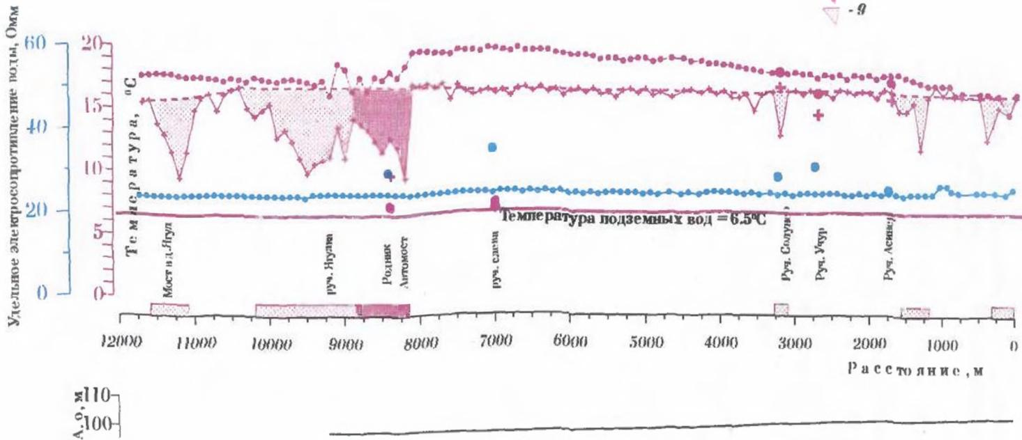
Рис. 4.2. Результаты геофизических работ по р.Луга (1, 2, 3 - температура донных отложений, температура и УЭС воды основного русла; 4, 5, 6 - то же для притоков и родников; 7 - линия фоновых значений температуры; 8, 9 - температурные аномалии и соответствующие им участки субаквальной разгрузки соответственно высокой и низкой интенсивности).
