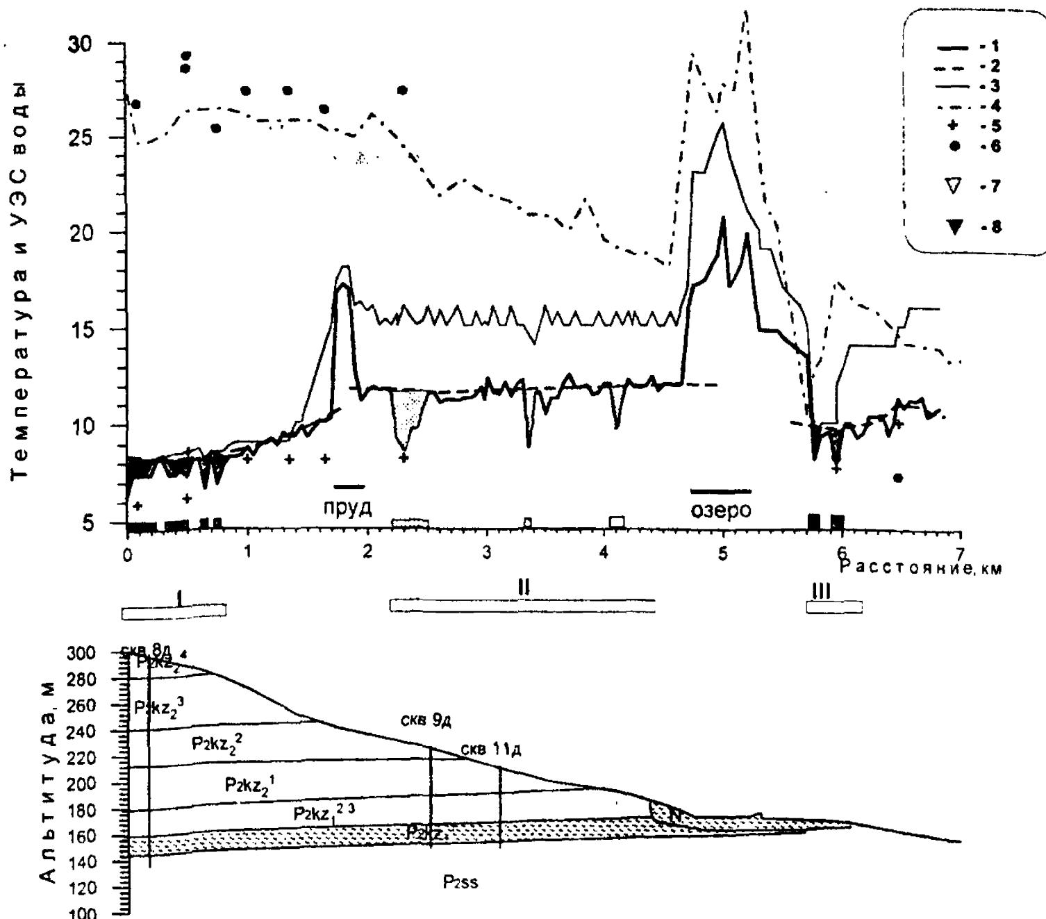
**Рис. 5.1. Результаты акваториальных геофизических исследований по ручью Сарсаз (1- температура отложений , 2- линия фоновых значений температуры, 3,4 - температура и УЭС воды основного русла, 5,6 - то же для родников, 7,8 - температурные аномалии и соответствующие им участки субаквальной разгрузки соответственно высокой и низкой интенсивности, I, II, III - зоны с различными условиями взаимодействия поверхностных и подземных вод).**
