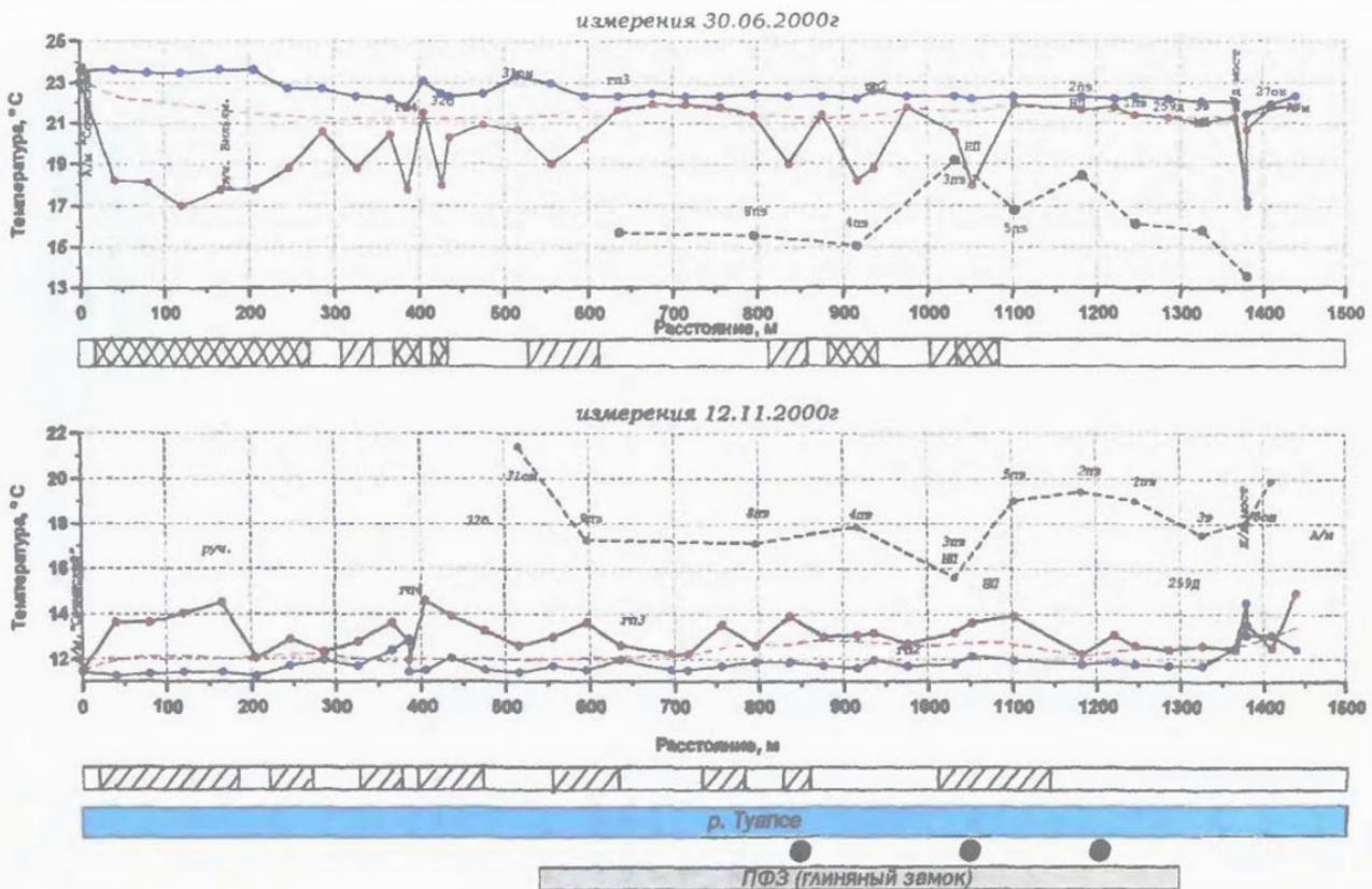
Рис. 5.7. Оценка эффективности защитной дренажной системы с применением термометрии (июнь, ноябрь 2000 г.).
