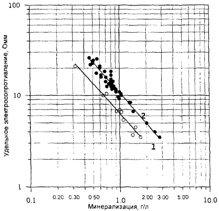
**Рис.4.7. Эмпирические зависимости между удельным электросопротивлением и минерализацией воды.( 1-Большекизильское МППВ, преимущественно гидрокарбонатные воды, 2- МППВ Татарстана, преимущественно сульфатные воды).**
