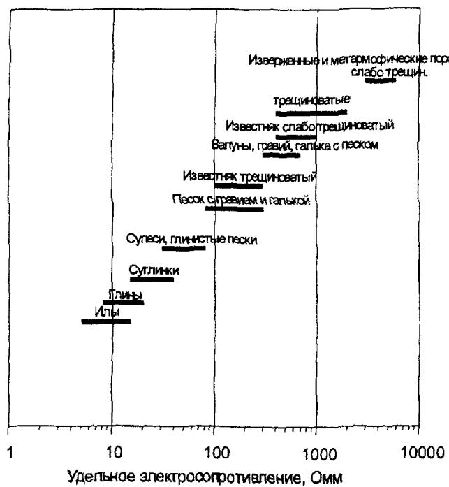
**Рис. 4.8.** Типовые значения удельного электросопротивления для основных литотипов.
