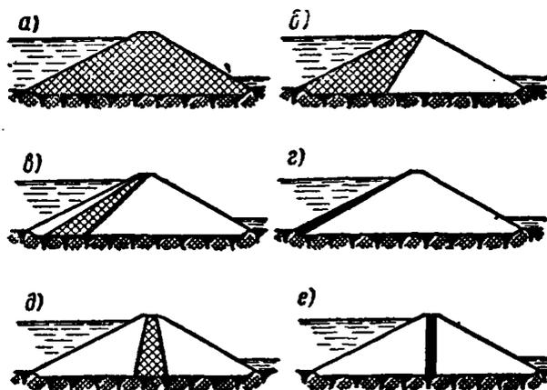
Рис. 1. Типы земляных насыпных плотин
