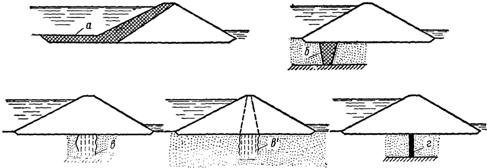
Рис. 2. Конструкции противofiltrационных устройств в основании
