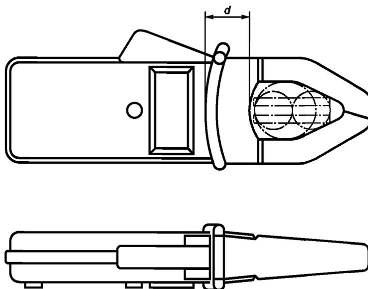
Рисунок 104 — Минимальный зазор между защитным ограждением и магнитопроводом
