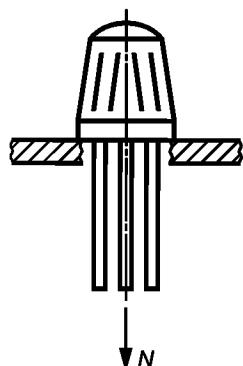
Рисунок 106 — Пример приложения усилия натяжения по оси зажима
