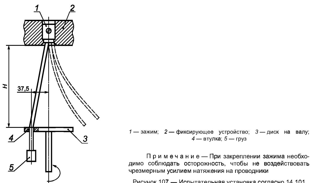
Рисунок 107 — Испытательная установка согласно 14.101
