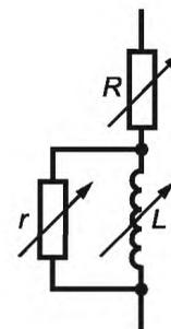
Рисунок А.2 — Элементы полного сопротивления  $Z$  или  $Z_1$
