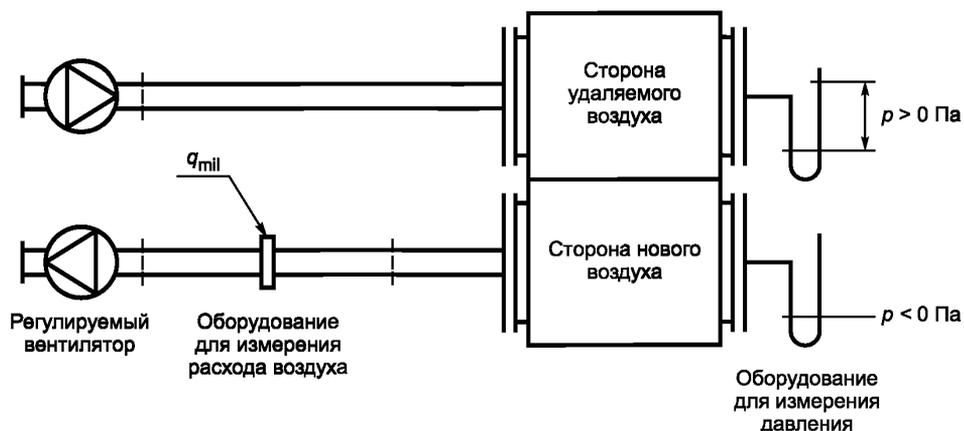
Рисунок 2 — Схема подключения оборудования при определении внутренних утечек
