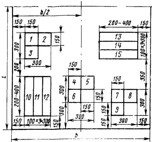
Образцы № 13; 14 и 15 предназначаются для определения предела прочности при изгибе в поперечном направлении.
