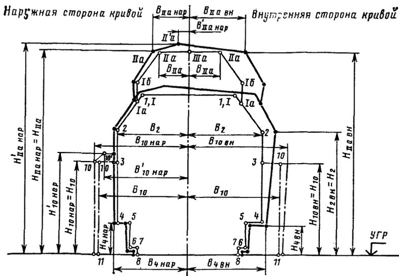
Рис. 9. Принцип построения габарита приближения строений С в кривых по проектным нормам:
