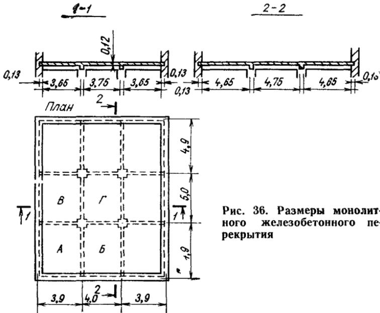
Рис. 36. Размеры монолитного железобетонного перекрытия
