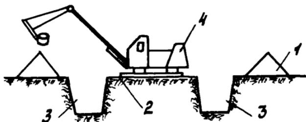
Рис. 21. Разработка одновременно двух траншей с одной технологической дороги:
