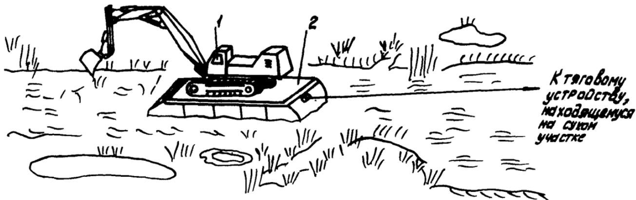
Рис.17. Разработка траншей на болотах 3-го типа одноковшовым экскаватором типа В0-4Г2Г, НД-1500, установленном на понтоне:
