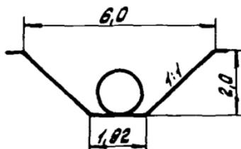
$$V = 7,8 \text{ м}^3 \text{ на } 1 \text{ м}$$
