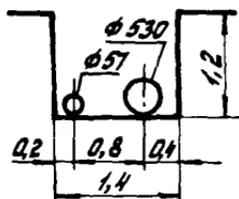
$$V = 1,58 \text{ м}^3 \text{ на } 1 \text{ м}$$
