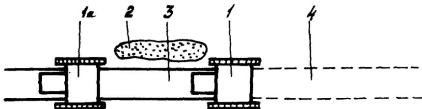
Рис.2. Технологическая схема разработки траншей роторными экскаваторами без оставления перемычек между захватками:
