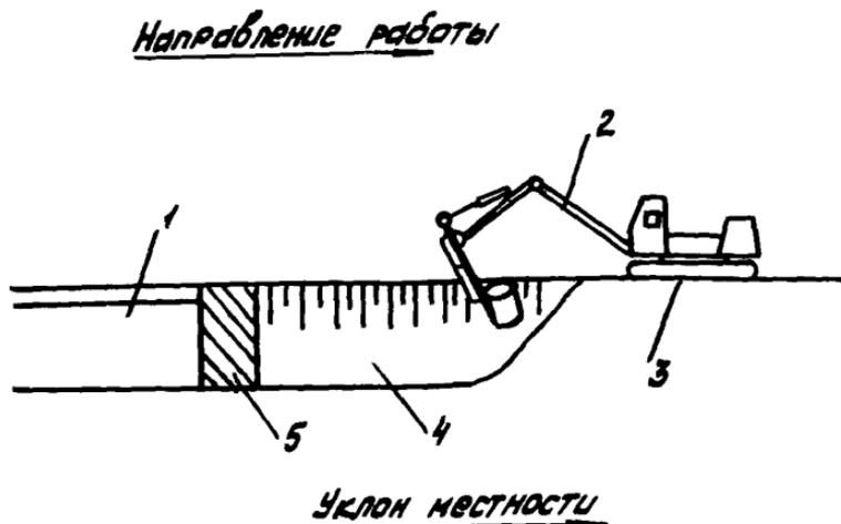
Рис.23. Разработка траншей на местности с высоким уровнем грунтовых вод:
