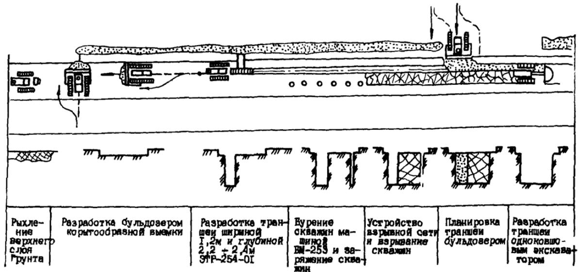
Рис.41. Разработка траншей в мерзлых грунтах крепостью до 400 ударов плотномер ДорНИИ с использованием роторных и одноковшовых экскаваторов
