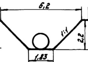
$V = 8,8 \text{ м}^3 \text{ на } 1 \text{ м}$
