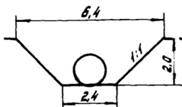
$$V = 8,8 \text{ м}^3 \text{ на } 1 \text{ м}$$
