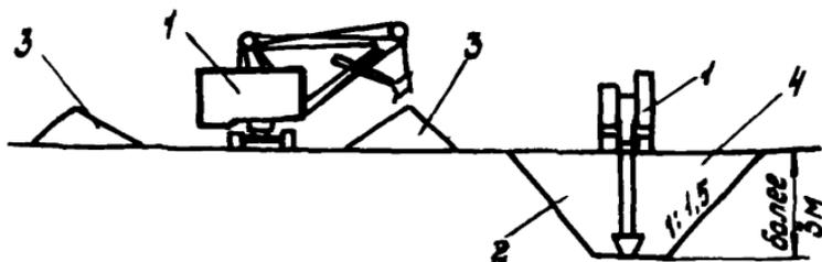
Рис.14. Разработка глубоких траншей в слабых грунтах с двойной перекидкой грунта:
