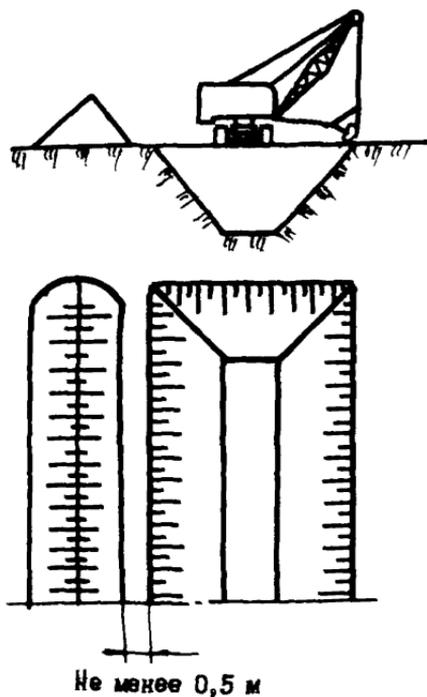
Рис. II. Разработка траншей на криволинейных участках трассы в устойчивых грунтах с использованием одноковшовых экскаваторов типа 80-4121 с обратной лопатой для больших диаметров и типа 652Б - для малых диаметров
