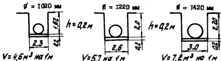
Ориентировочный профиль траншеи на болотах III типа, образованный взрывом
