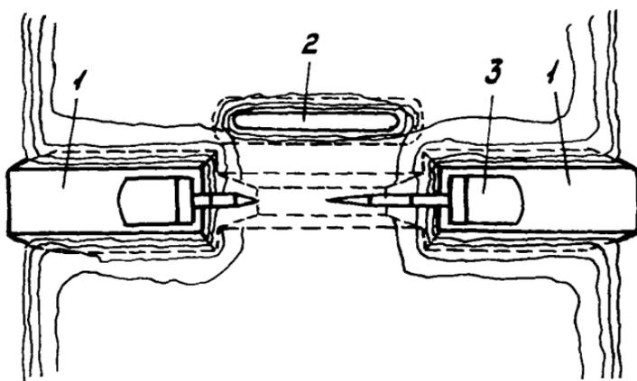
Рис.19. Разработка траншей на обводненной местности
