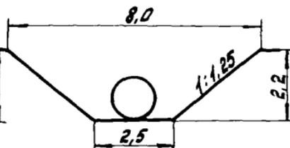
$$V = 11,5 \text{ м}^3 \text{ на } 1 \text{ м}$$
