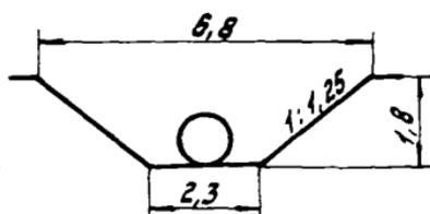
$$V = 8,3 \text{ м}^3 \text{ на } 1 \text{ м}$$
