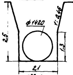
$V=5,85\text{ м}^3 \text{ на } 1\text{ м}$
