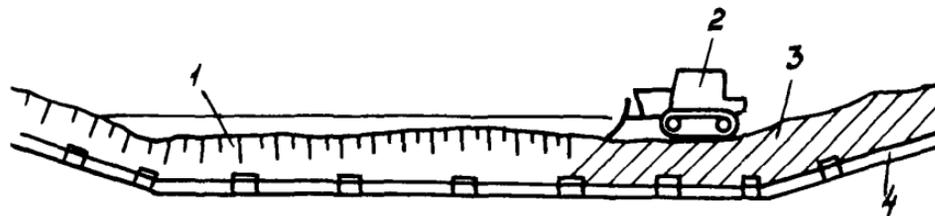
Рис.55. Засыпка траншей пионерным способом, проложенных через водоемы глубиной до 0,5 м, с использованием бульдозера:
