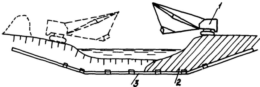
Рис.57. Засыпка траншей пионерным способом, проложенных через водоемы глубиной более 0,5 м, с использованием одноковшового экскаватора с ковшом драглайн:
