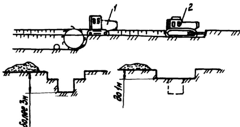
Рис.27. Разработка глубоких траншей в устойчивых песчаных грунтах с использованием бульдозера и роторного экскаватора:
