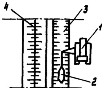
Рис.15. Планировка дна траншеи способом протаскивания клин-бабы (шар-бабы):
