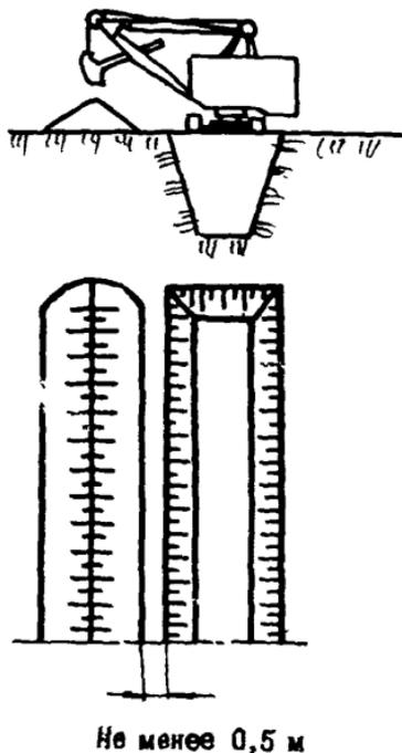
Рис.10. Разработка траншей в обводненных грунтах на криволинейных участках трассы с использованием одноковшовых экскаваторов тех же типов, оборудованных ковшом драглайн
