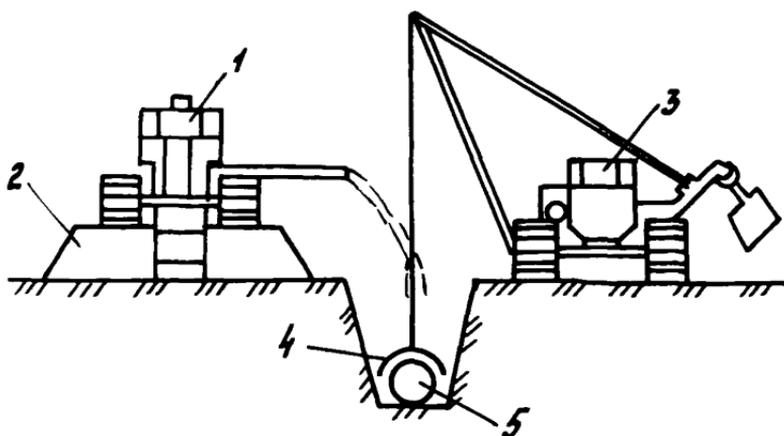
Рис.53. Засыпка трубопровода мерзлым грунтом после его рыхления в отвале механическим или буро-взрывным способом:
