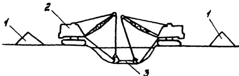
Рис.22. Разработка подводной траншеи с двух берегов водоема одновременно двумя экскаваторами с драглайном со связанными ковшами:
