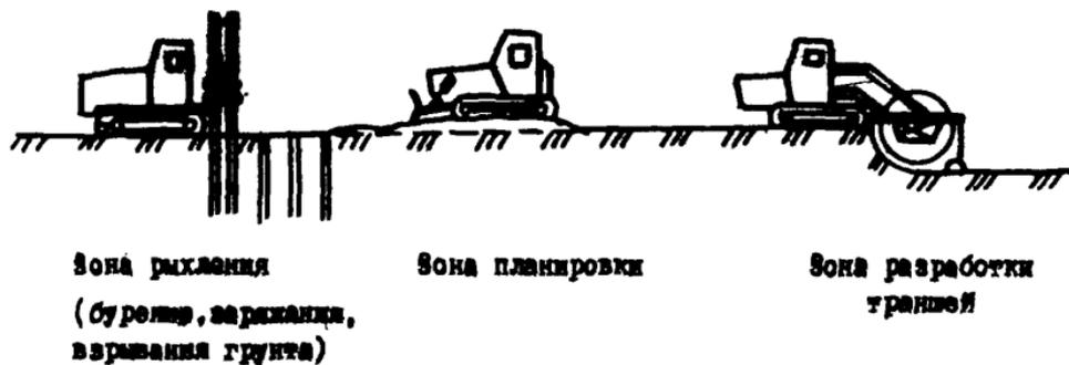
Рис. 39. Разработка траншей в мерзлых грунтах с крепостью более 400 ударов плотномера ДорНИИ с использованием буровой машины, бульдозера и роторного экскаватора на прямолинейных участках трассы
