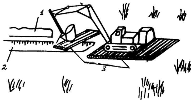
Рис.49. Разработка траншей одноковшовым экскаватором 90-4I2I, 90-4I23 на болотах с несущей способностью от  $0,1$  до  $0,2 \text{ кгс/см}^2$ :
