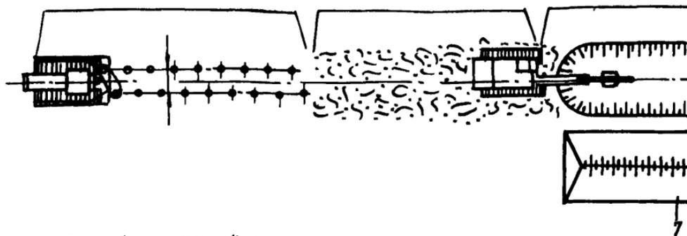
Рис. 38. Разработка траншей одноковшовым экскаватором с предварительным рыхлением грунта буро-взрывным способом:
