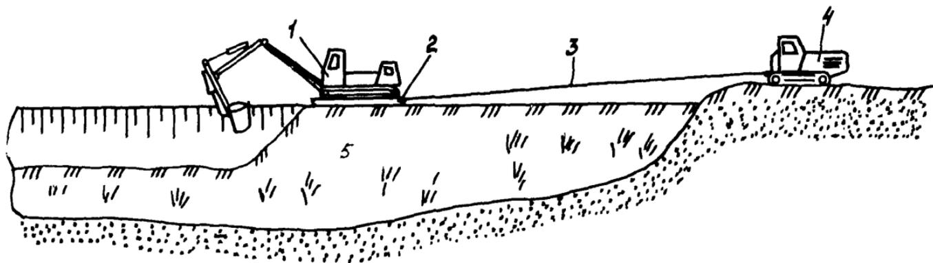
Рис.16. Разработка траншей на болоте одноковшовым экскаватором, установленным на пеноволокуше:
