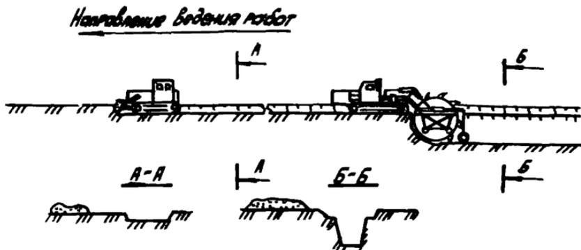
Рис.7. Комбинированный способ разработки глубоких траншей и на увлажненных грунтах, в том числе при балластировке трубопроводов с использованием бульдозеров класса И5-25 т и роторных экскаваторов типа 8ТР-254
