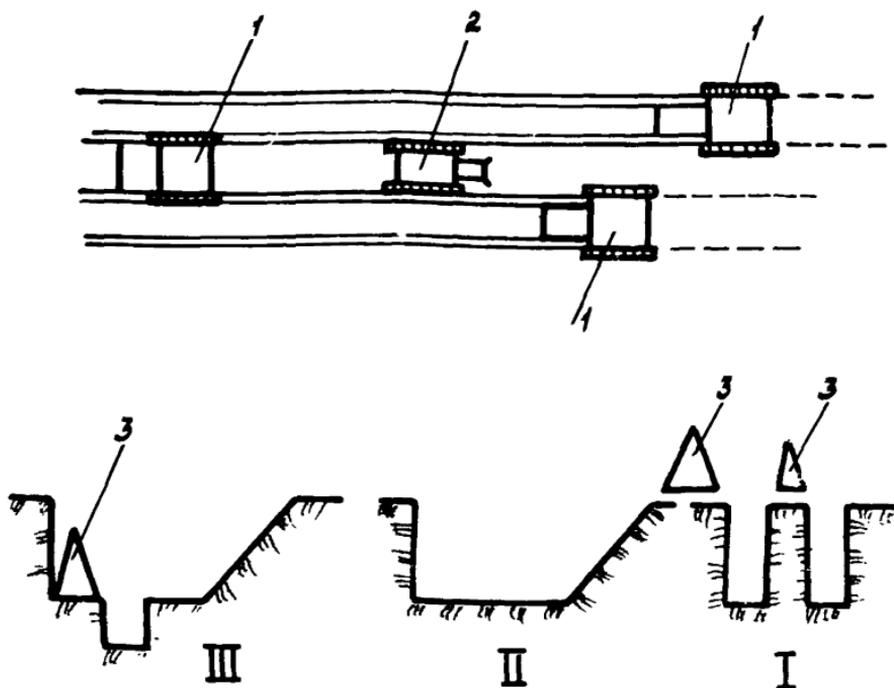
Рис.9. Разработка глубоких траншей и на увлажненных грунтах, в том числе при балластировке трубопроводов с использованием роторных экскаваторов типа ЭТР-253, ЭТР-254 и бульдозеров класса И5-25 т:
