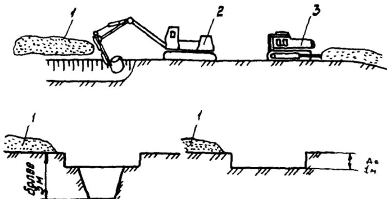
Рис.25. Разработка глубоких траншей в песчаных грунтах с использованием бульдозера и одноковшового экскаватора:
