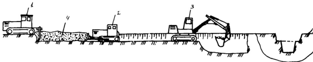
Рис.12. Разработка траншей в сложных условиях, в том числе требующих механического рыхления грунта:
