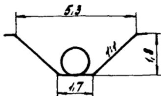
$$V = 6,3 \text{ м}^3 \text{ на } 1 \text{ м}$$
