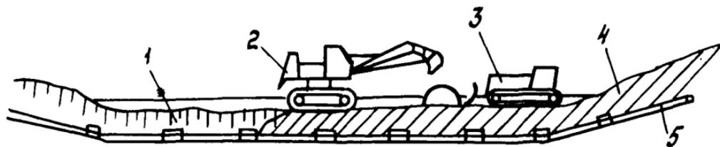
Рис. 56. Засыпка траншей пионерным способом, проложенных через водоемы глубиной до 0,5 м, с использованием однокошовой экскаватора с обратной лопатой:
