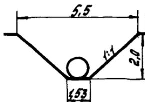
$V = 7,1 \text{ м}^3 \text{ на } 1 \text{ м}$
