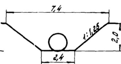
$$V = 10 \text{ м}^3 \text{ на } 1 \text{ м}$$
