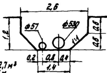
$$V = 2,7 \text{ м}^3 \text{ на } 1 \text{ м}$$
