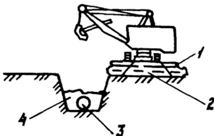
Рис.5I. Засыпка траншеи, расположенной на болоте, одноковшовым экскаватором, установленным на сланях, уложенных на спланированном отвале грунта:
