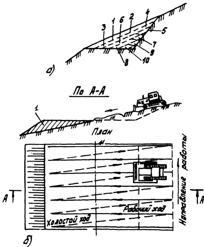
Рис.35. Технологическая схема устройства полки (полунасыпь-полувыемка) поперечными ходами бульдозера:
