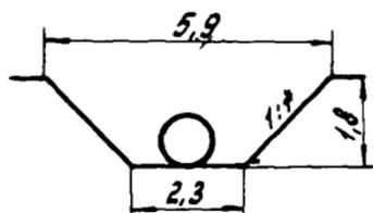
$$V = 7,7 \text{ м}^3 \text{ на } 1 \text{ м}$$
