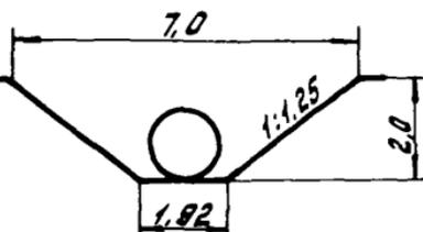
$$V = 8,84 \text{ м}^3 \text{ на } 1 \text{ м}$$
