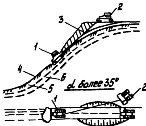
Рис.36. Разработка траншей лотковым способом:
