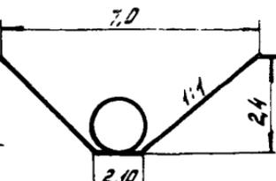
$V = 10,1 \text{ м}^3 \text{ на } 1 \text{ м}$
