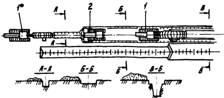
Рис.8. Разработка глубоких траншей и на увлажненных грунтах, в том числе при балластировке трубопроводов с использованием роторных экскаваторов типа ЭТР-253, ЭТР-254 и бульдозеров класса 15-25 т:
