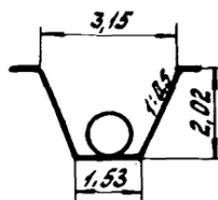
$V = 5,3 \text{ м}^3 \text{ на } 1 \text{ м}$
