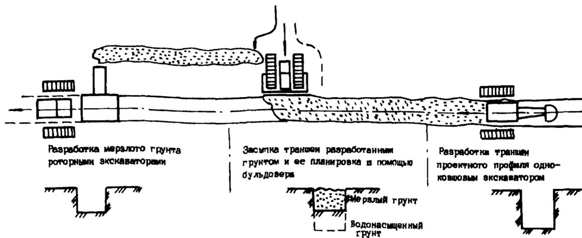
Рис.46. Разработка траншей в мерзлых грунтах, подстилаемых водонасыщенными грунтами
