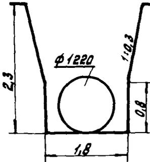
$V=4,74\text{ м}^3 \text{ на } 1\text{ м}$
