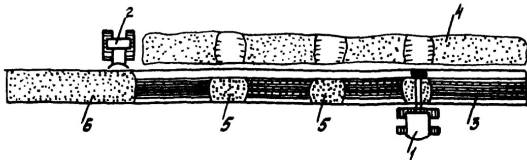
Рис.58. Технология засыпки многониточных трубопроводов, уложенных в общей траншее:
