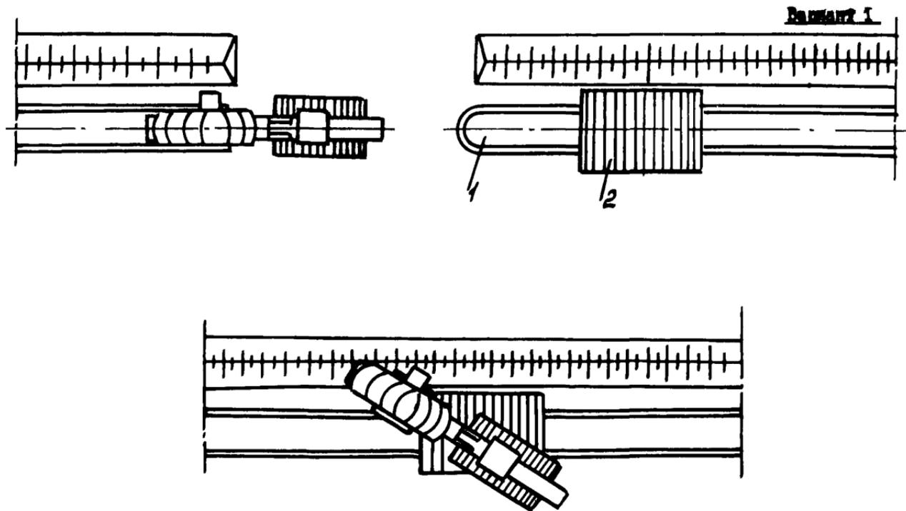
Рис. I. Разработка траншеи роторными экскаваторами без оставления перемычки между захватками с использованием инвентарных щитов:
