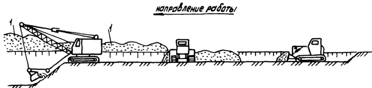
Рис.25. Разработка траншей в песчаных грунтах комбинированным способом:
