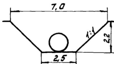
$$V = 10,3 \text{ м}^3 \text{ на } 1 \text{ м}$$
