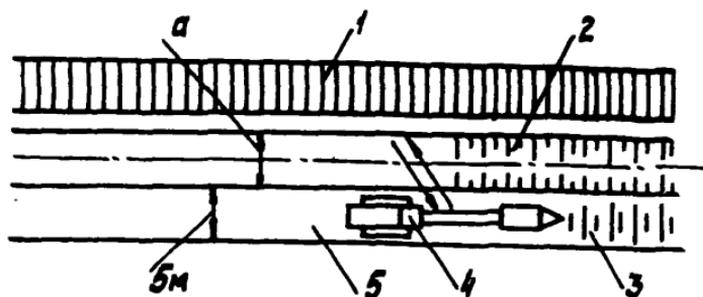
Рис.48. Разработка траншеи поперечными черпаниями грунта экскаватором-драглайном с промороженной полосой:
