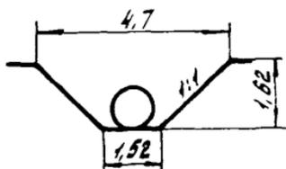
$$V = 5,1 \text{ м}^3 \text{ на } 1 \text{ м}$$
