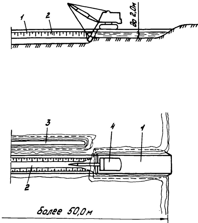
Рис.20. Разработка траншей на обводненной местности (в том числе через озера) шириной более 50 м и глубиной до 2 м:
