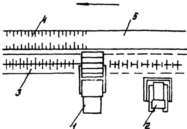
Рис.54. Засыпка траншей с использованием траншеезасыпателя и бульдозера при большом объеме засыпки:
