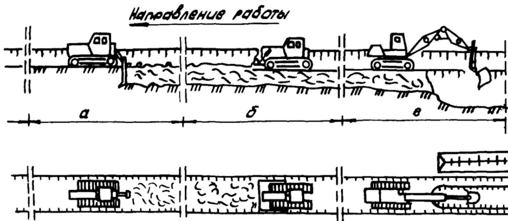
Рис.37. Разработка траншей в мерзлом грунте с использованием механического рыхлителя:
