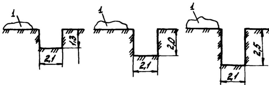
Рис.6. Разработка траншей в плотных нескальных (ракушечник, мягкий известняк и др.) и мерзлых грунтах крепостью до 400 кгс/см<sup>2</sup> с последовательным увеличением глубины траншеи роторными экскаваторами типа ЭТР-253 и ЭТР-254: 1 - отвал грунта
