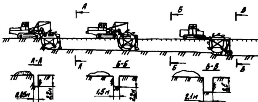
Рис.5. Разработка траншей в плотных некаменных (глинистых, мягкий известняк и др.) и мерзлых грунтах крепостью до 400 кгс/см<sup>2</sup> с последовательным увеличением ширины траншей роторными экскаваторами типа ЭТР-253 и ЭТР-254
