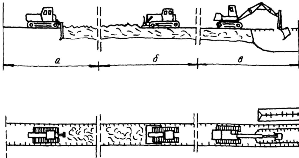
Рис.28. Разработка траншей в сыльных грунтах с коэффициентом крепости по Протодья-конову до  $f = 5$  с использованием стоечных рыхлителей с тяговым усилием 30-40 тс бульдозеров класса 15-25т и одноковшовых экскаваторов типа 90-4121:
