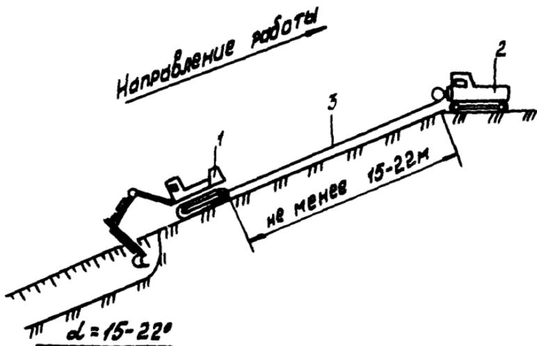
Рис.31. Разработка траншей на продольных уклонах  $15-22^{\circ}$  одноковшовым экскаватором с обратной лопатой по принципу "снизу вверх":
