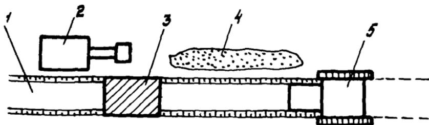
Рис.3. Разработка перемычки с помощью одноковшового экскаватора:
