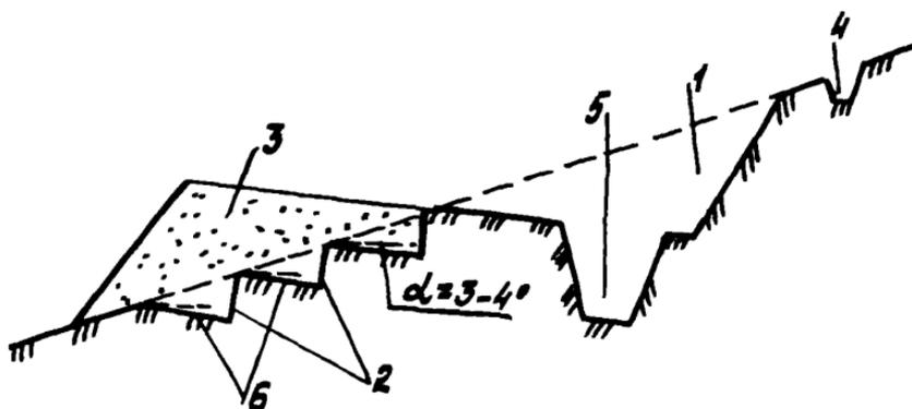
Рис.32. Поперечный разрез полки: 1 - полувыемка; 2 - уступы для устойчивости полунасыпи; 3 - полунасыпь; 4 - нагорная водоотводная канава; 5 - траншея под трубопровод; 6 - обратный уклон полувыемки
