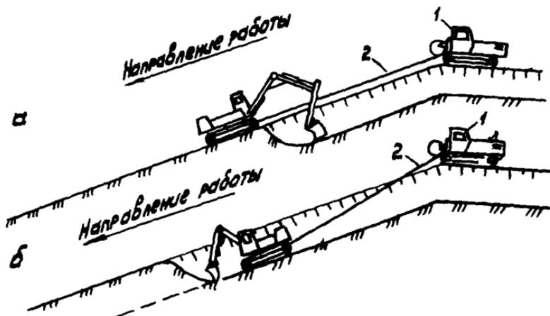
Рис.30. Разработка траншей на продольных уклонах более  $22^{\circ}$  одноковшовыми экскаваторами по принципу "сверху вниз":
