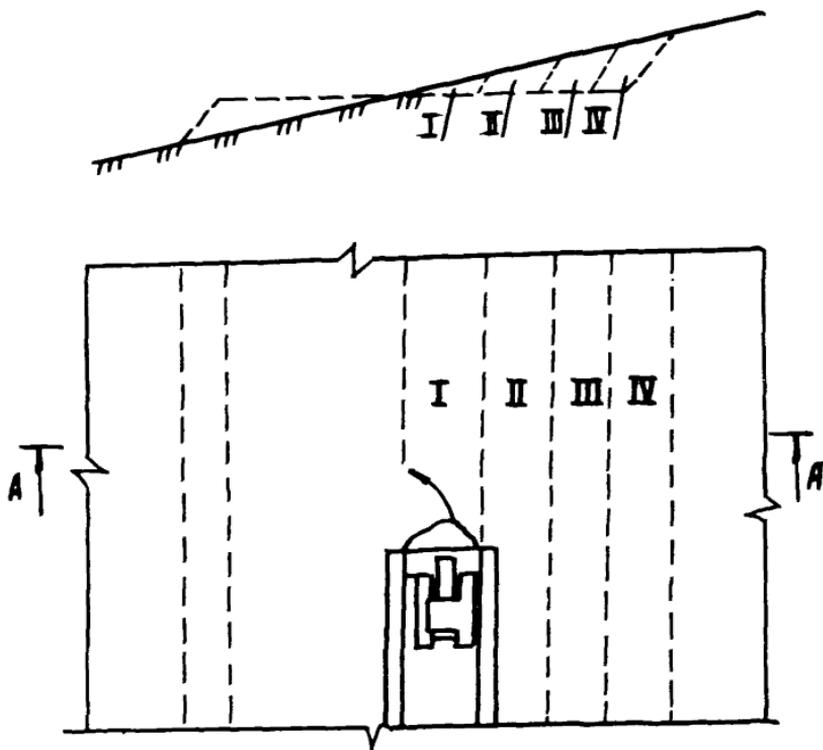
Рис. 34. Разработка полки типа полунасыпь-полувыемка продольными проходами бульдозера
