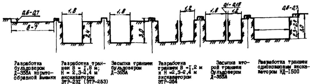
Рис. 40. Разработка траншей в мерзлых грунтах прочностью до 400 ударов плот-
