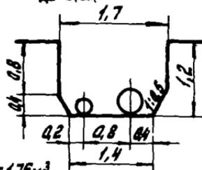
$$V = 1,75 \text{ м}^3 \text{ на } 1 \text{ м}$$
