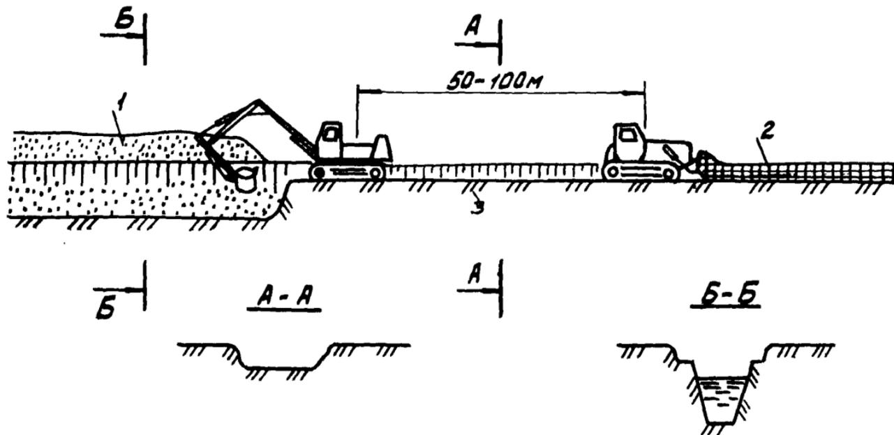
Рис.18. Разработка траншей на болоте с несущим подстилающим основанием, с предварительным выторфовыванием с помощью бульдозера:
