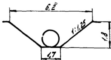
$$V = 7,2 \text{ м}^3 \text{ на } 1 \text{ м}$$
