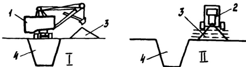
Рис.13. Разработка траншей в стесненных условиях с использованием одноковшового экскаватора, с укладкой отвала грунта на рабочую полосу с последующей его планировкой бульдозером:
