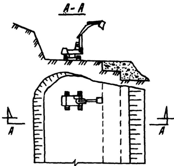
Рис.33. Разработка полки одноковшовым экскаватором
