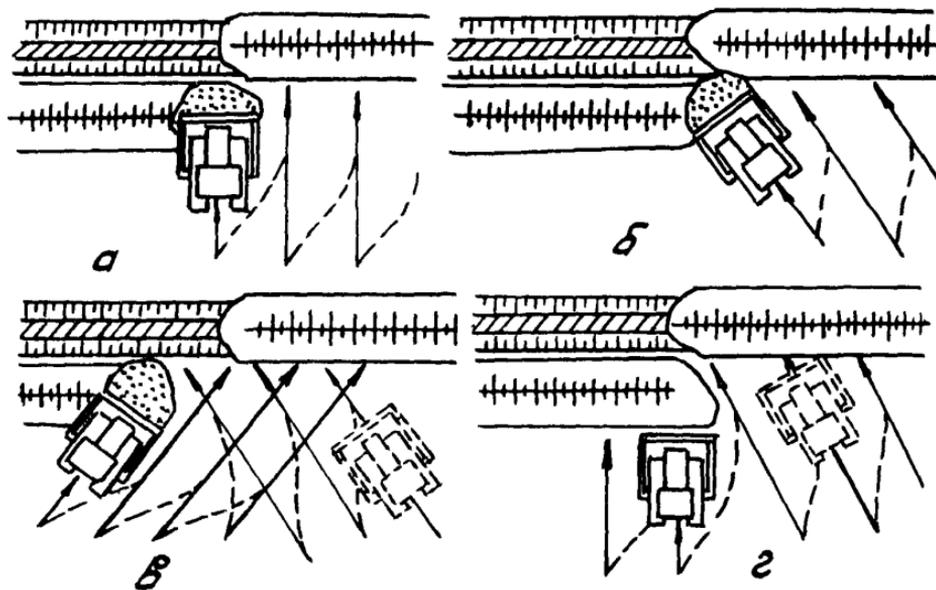
Рис.50. Схема производства работ по засылке уложенного трубопровода бульдозером:
