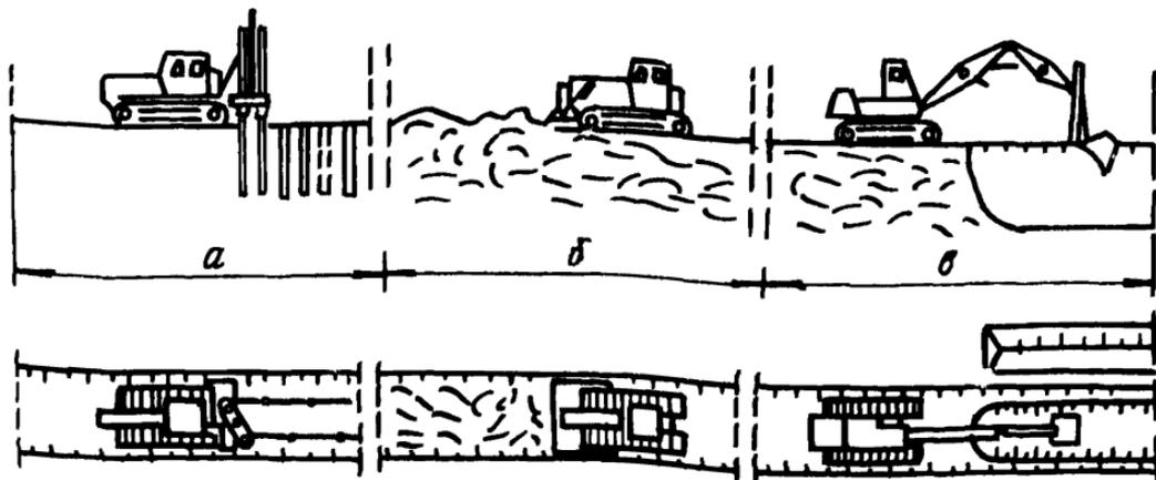
Рис.29. Разработка траншей в скальных грунтах с коэффициентом крепости по Протодьяконову более 5 буро-взрывным способом с использованием буровой машины БМ-254, бульдозера класса И5-25Т и одноковшового экскаватора типа 80-4121:
