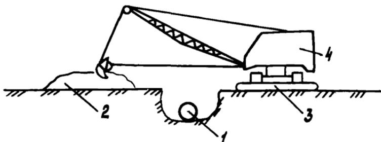
Рис. 52. Засыпка траншеи на болотах одноковшовым экскаватором-драглайном с технологической дороги:
