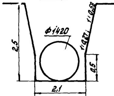
$V=6,85\text{ м}^3 \text{ на } 1\text{ м}$
