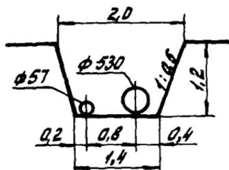
$$V = 3,36 \text{ м}^3 \text{ на } 1 \text{ м}$$
