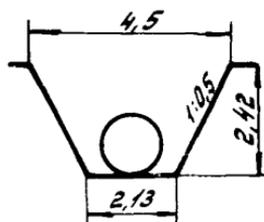
$V = 8,1 \text{ м}^3 \text{ на } 1 \text{ м}$
