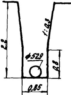
$V=2,6\text{ м}^3 \text{ на } 1\text{ м.}$
