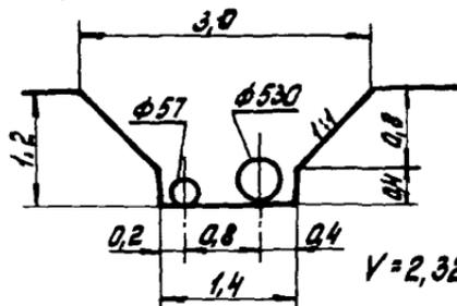
$$V = 2,32 \text{ м}^3 \text{ на } 1 \text{ м}$$
