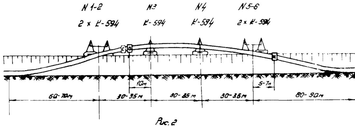
6.2. На уклонах более  $12^{\circ}$  и при большом количестве криволинейных участков трубопровод прокладывают из отдельных труб.
