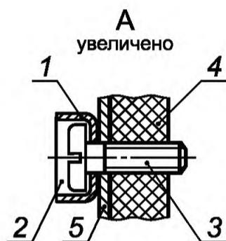
1 — шайба чашеобразная М5; 2 — мастика для оттиска клейма; 3 — винт М4; 4 — лицевая панель прибора;
