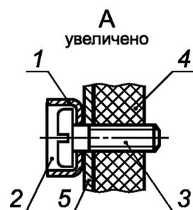
1 — шайба чашеобразная М5; 2 — мастика для оттиска клейма; 3 — винт М4; 4 — задняя панель; 5 — корпус прибора
