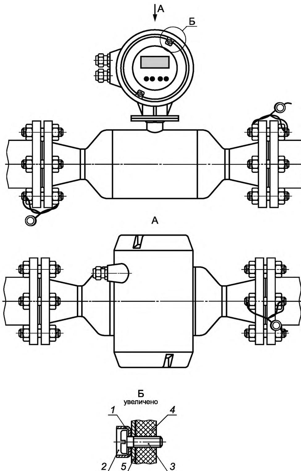
1 — шайба чашеобразная М5; 2 — мастика для оттиска клейма; 3 — винт М4; 4 — корпус прибора; 5 — крышка датчика
