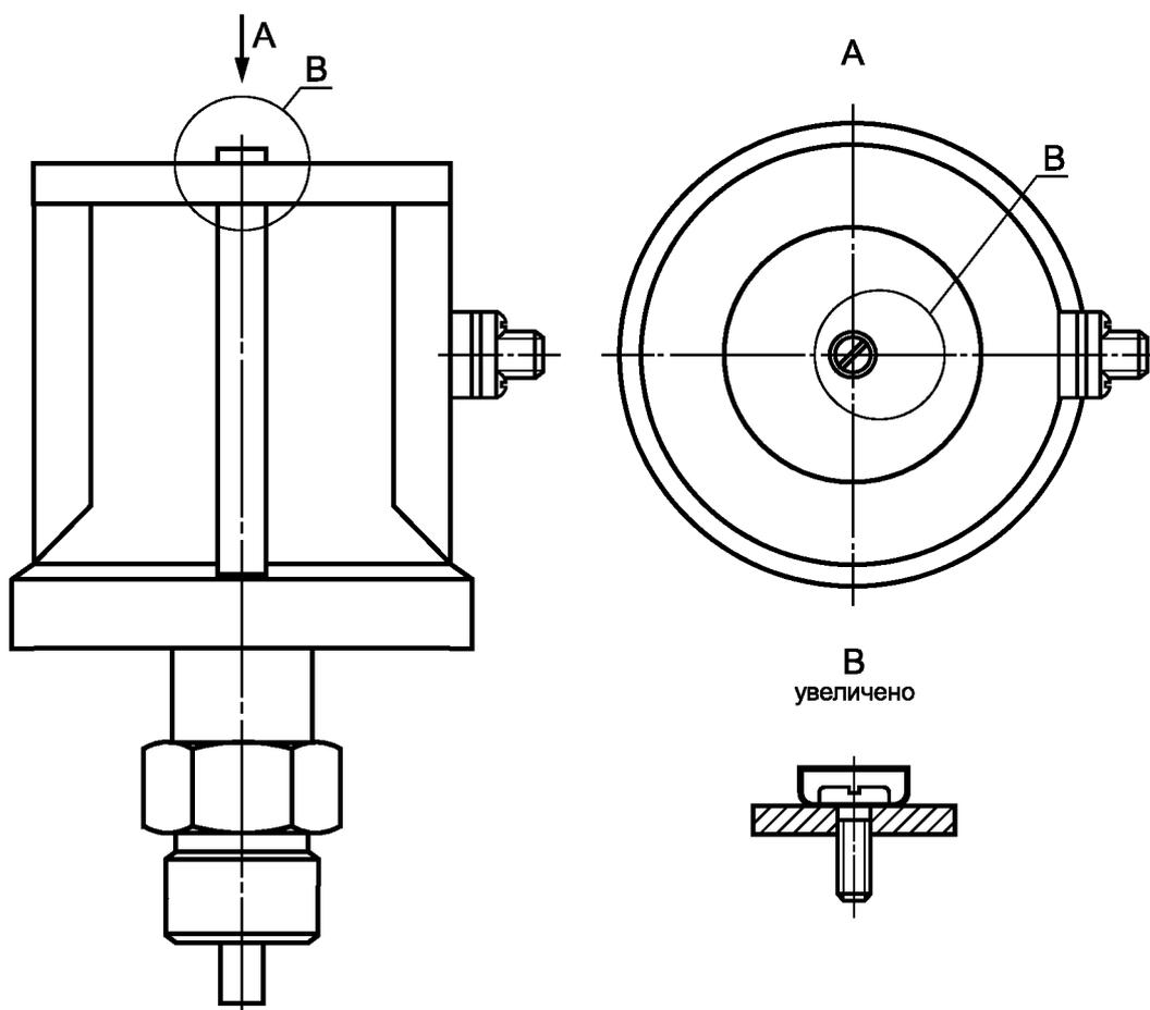
Рисунок Б.18 — Датчик давления МЕТРАН-55-Д, МЕТРАН-55-Ex-Д, группы предприятий МЕТРАН
