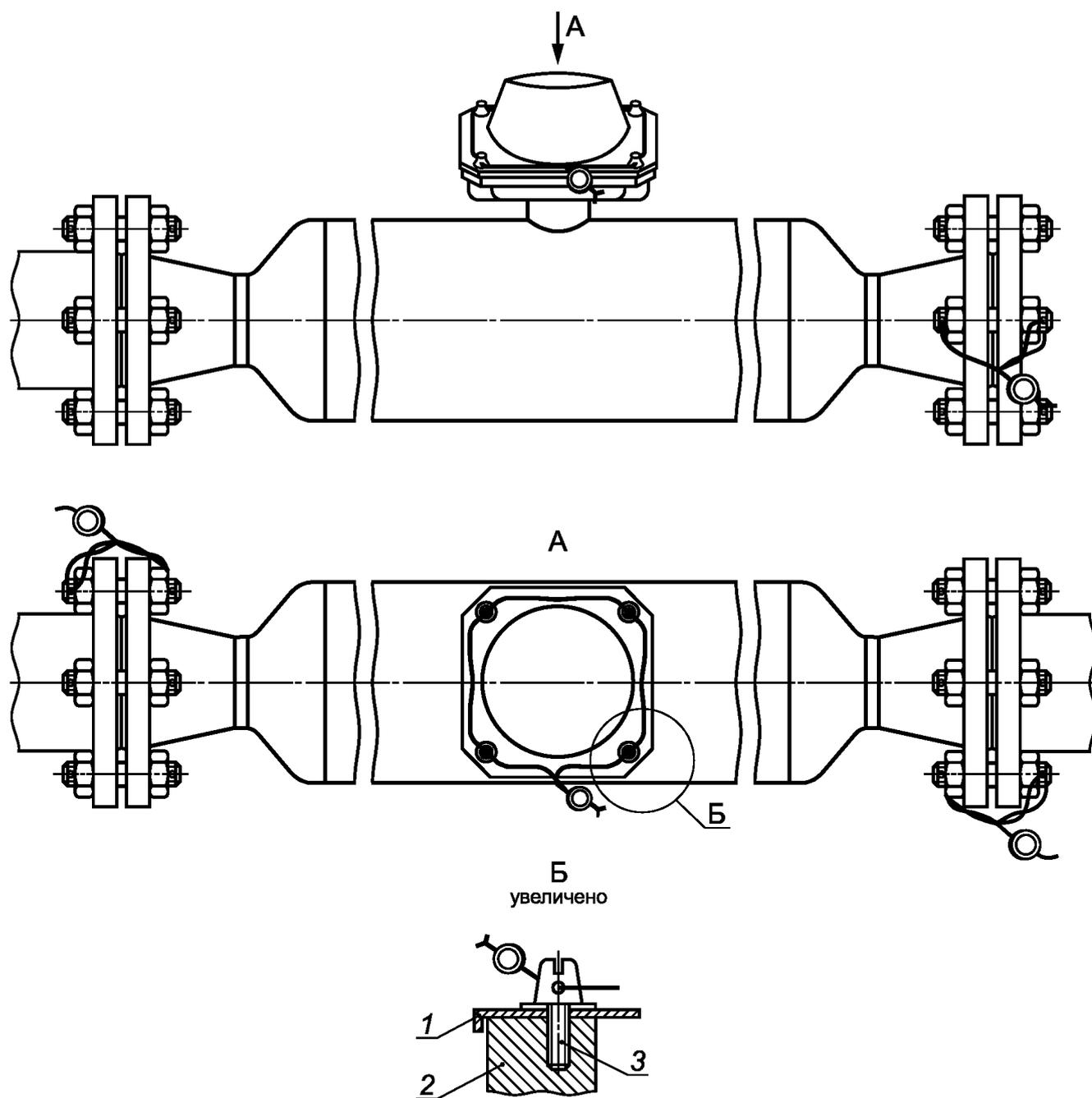
1 — крышка соединительной коробки; 2 — корпус соединительной коробки; 3 — крепежный винт под контрольную проволоку
