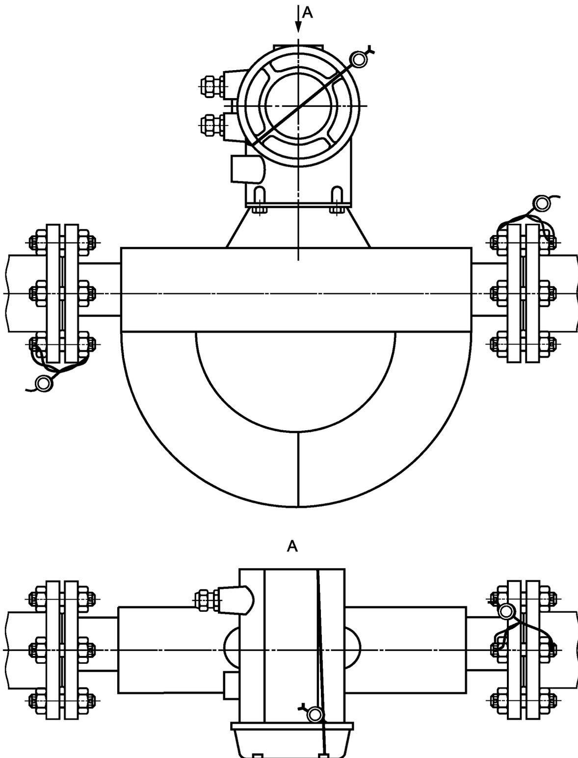
Рисунок Б.4 — Преобразователь расхода массовый ROTAMASS цельноблочного исполнения RCCT3
