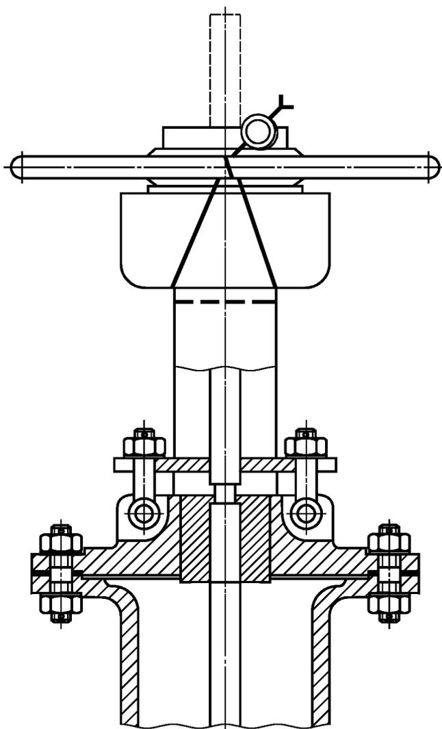
Рисунок Б.43 — Задвижка стальная клиновья с выдвижным шпинделем
