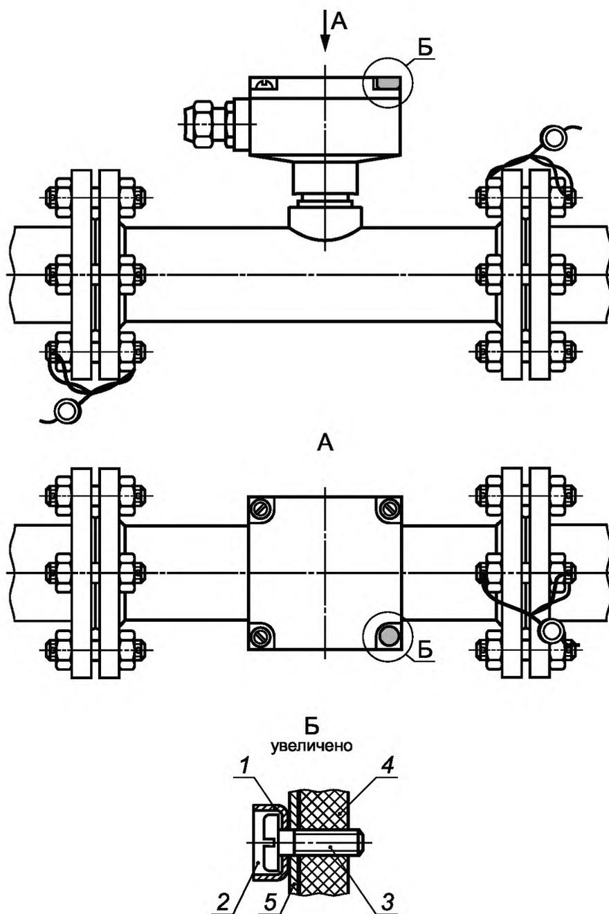
1 — шайба чашеобразная М5; 2 — мастика для оттиска клейма; 3 — винт М4; 4 — корпус;
