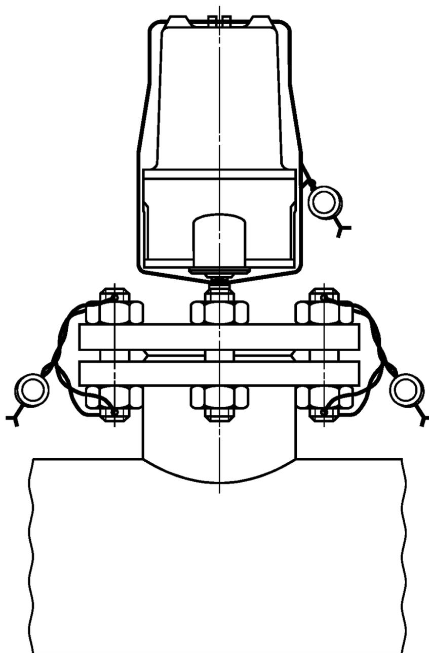
Рисунок Б.34.1 — Влагомер поточный фирмы «Phase Dynamics, Inc.».
