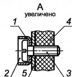
1 — шайба чашеобразная М5; 2 — мастика для оттиска клейма; 3 — винт М4; 4 — передняя панель; 5 — корпус прибора
