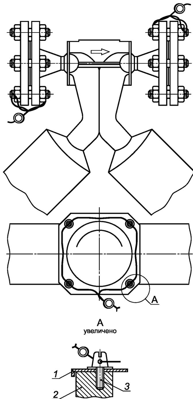
1 — крышка соединительной коробки; 2 — корпус соединительной коробки;
