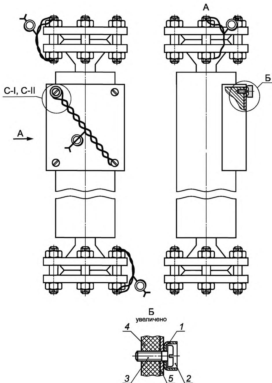
1 — шайба чашеобразная М5; 2 — мастика для оттиска клейма; 3 — винт М4; 4 — задняя крышка прибора; 5 — корпус прибора
