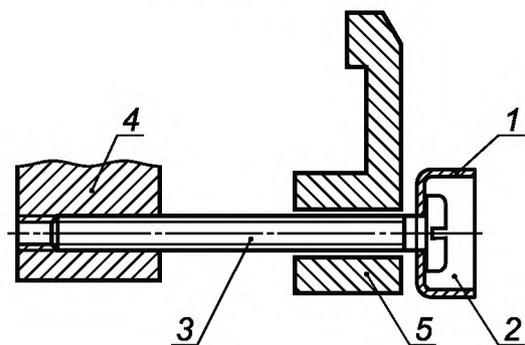
1 — шайба чашеобразная М5; 2 — мастика для оттиска клейма; 3 — винт М4; 4 — корпус прибора; 5 — зажим
