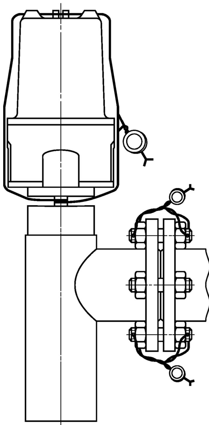
Рисунок Б.34.2 — Влагомер поточный фирмы «Phase Dynamics, Inc.».
