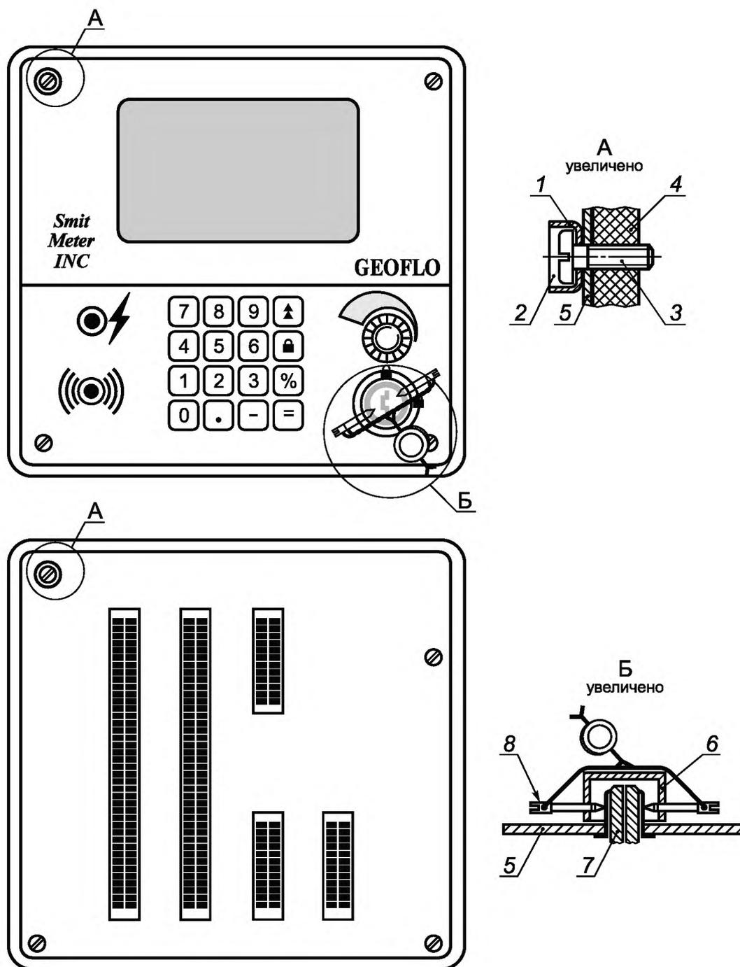
1 — шайба чашеобразная М5; 2 — мастика для оттиска клейма; 3 — винт М4; 4 — передняя крышка прибора;
