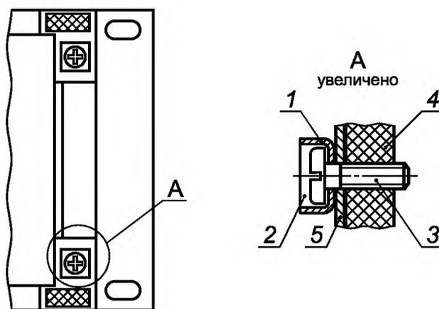
1 — шайба чашеобразная М5; 2 — мастика для оттиска клейма; 3 — винт М4; 4 — панель задняя; 5 — корпус прибора
