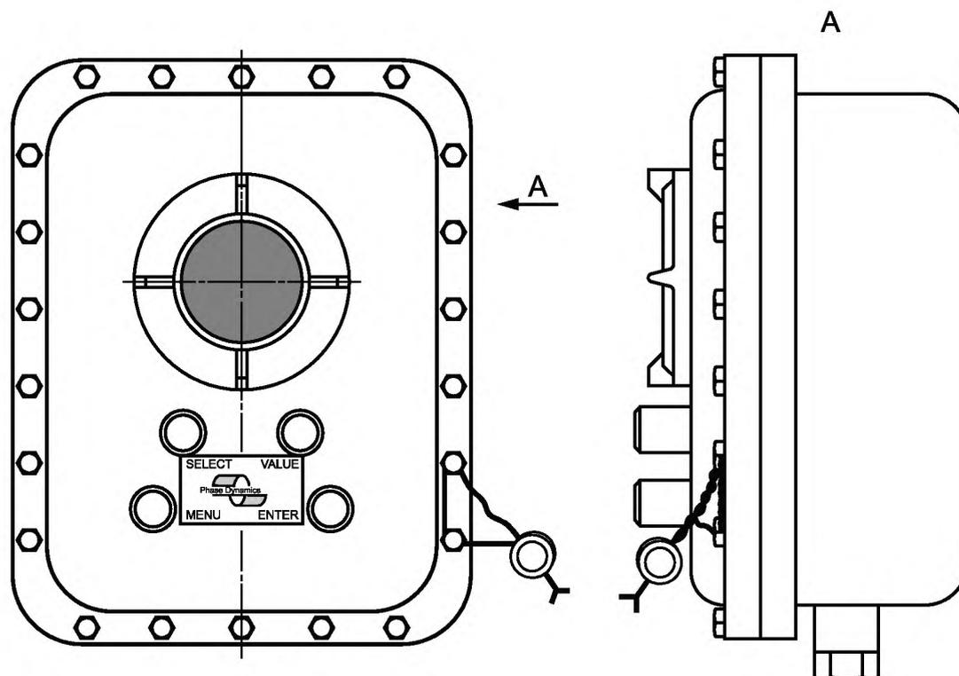
Примечание — В головке болта предусмотреть отверстие для пропуска пломбировочной проволоки.
