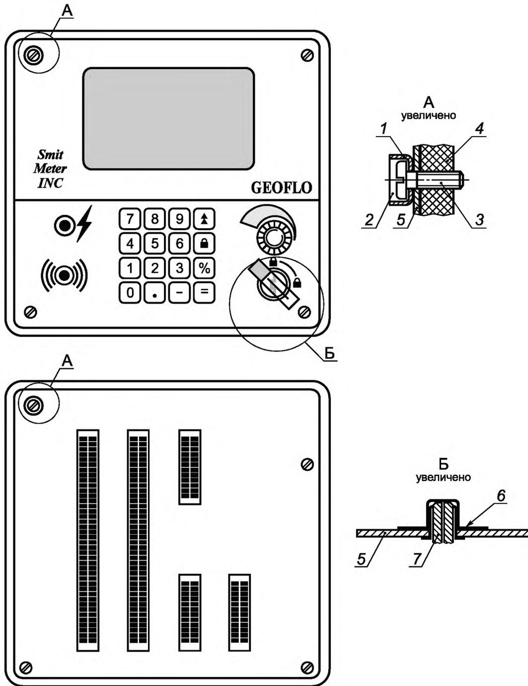
1 — шайба чашеобразная М5; 2 — мастика для оттиска клейма; 3 — винт М4; 4 — передняя крышка прибора; 5 — корпус прибора; 6 — корпус замка; 7 — голографическая наклейка обслуживающей организации
