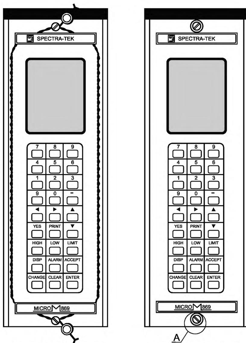
Вариант 1 пломбирования
