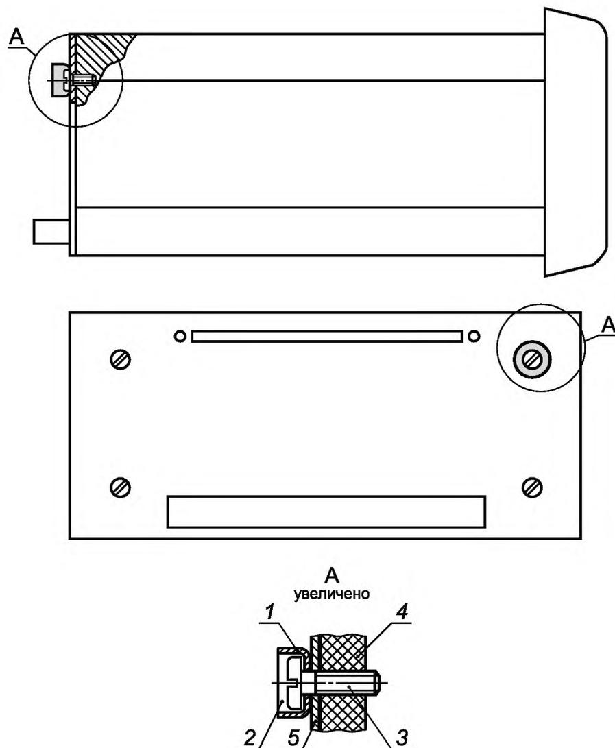
1 — шайба чашеобразная М5; 2 — мастика для оттиска клейма; 3 — винт М4; 4 — задняя крышка прибора;
