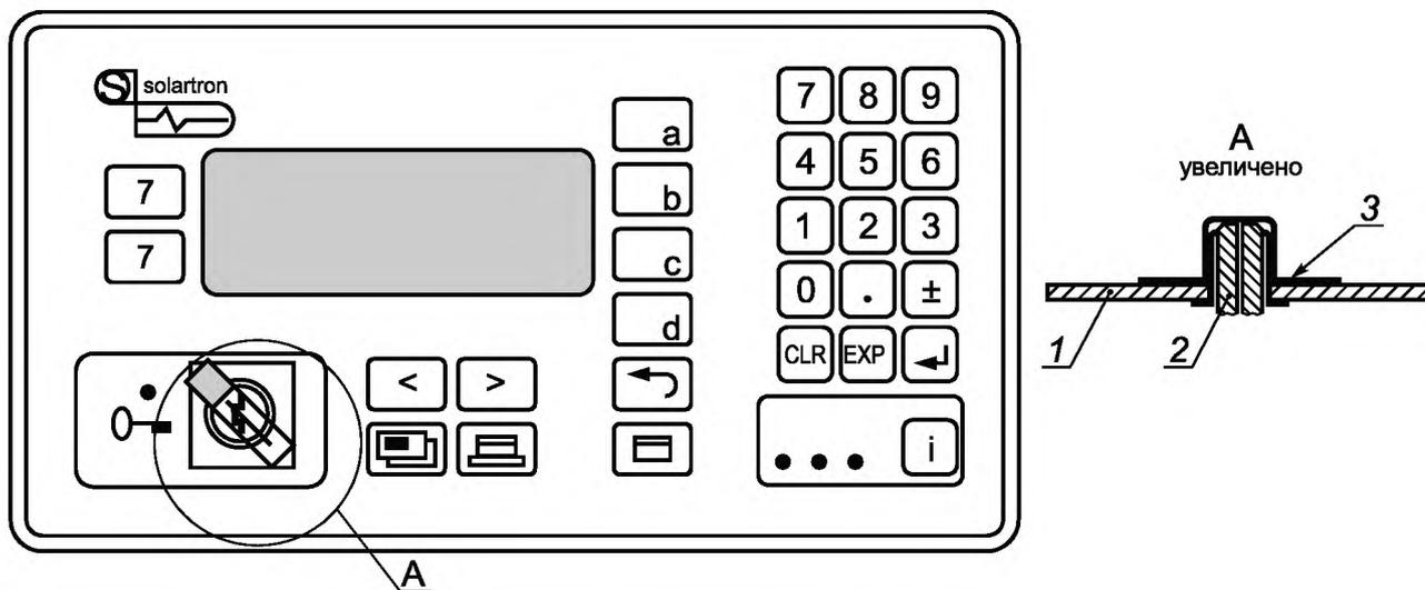
1 — передняя крышка прибора; 2 — корпус замка; 3 — голографическая наклейка обслуживающей организации
