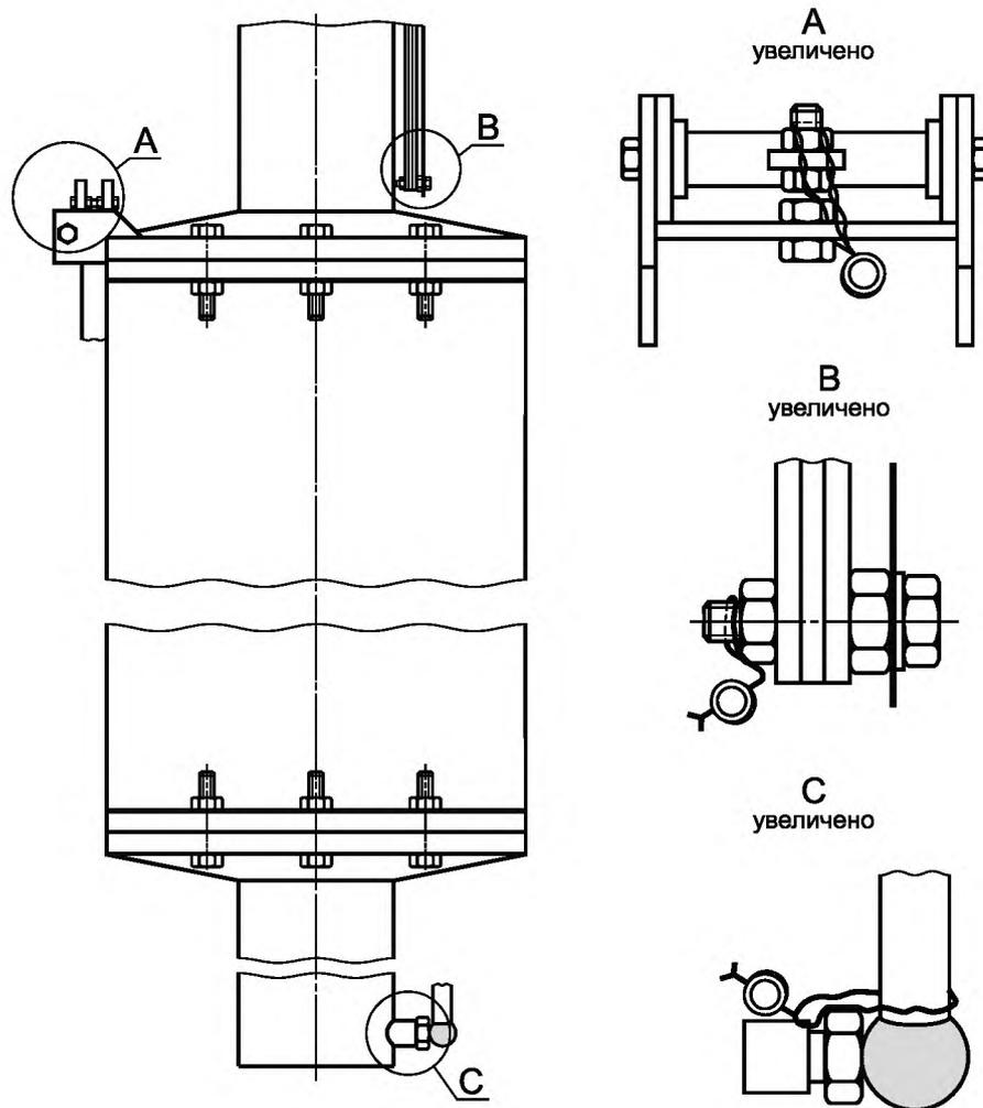
Рисунок Б.37 — Мерник образцовый МIP фирмы «Energoinvest»
