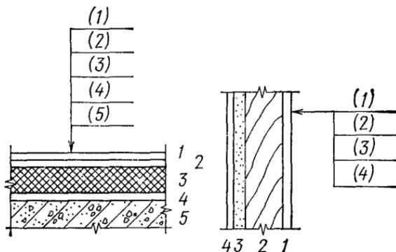
Примечание. Цифрами условно обозначена последовательность расположения слоев конструкции и надписей на линиях-выносах.
