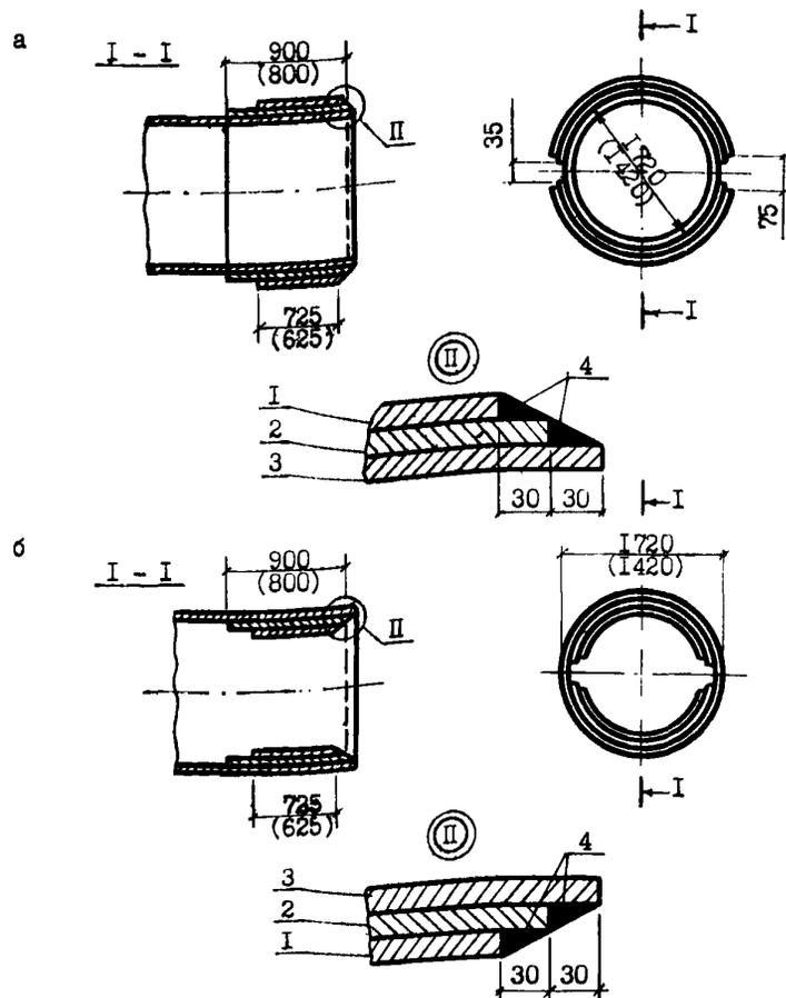
Рис. 2 Нож кольцевой для продавливания защитного футляра:
