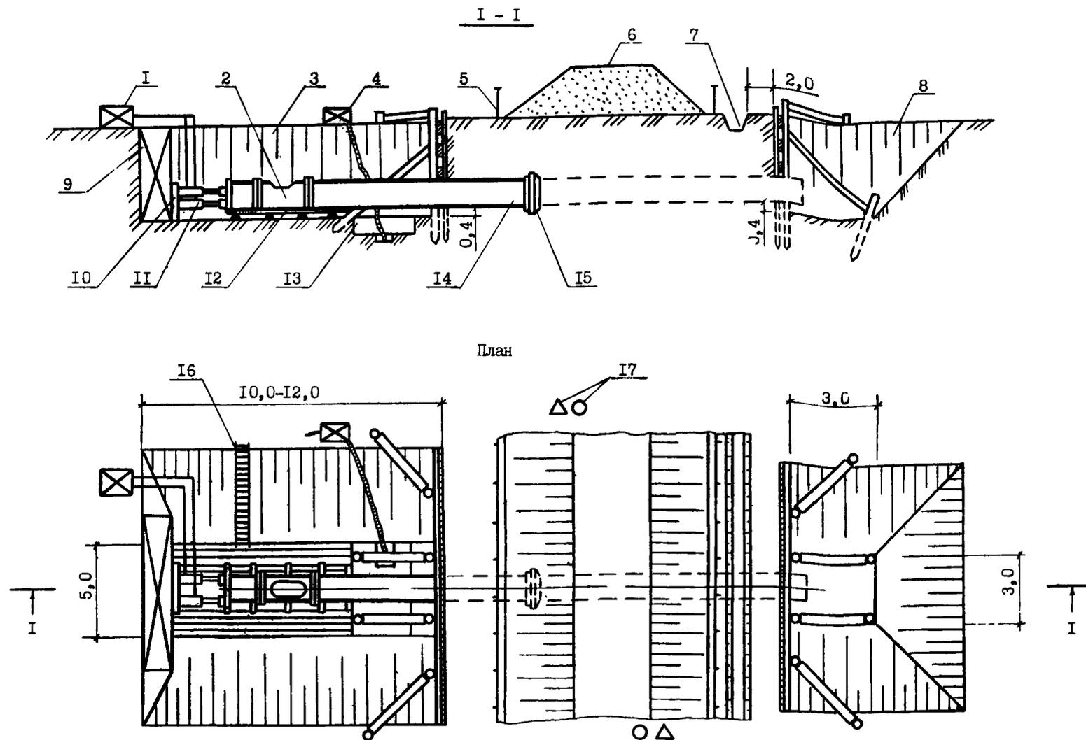
Рис. 1 Схема продавливания защитного футляра:
