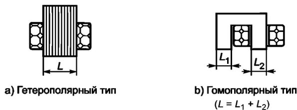
Рисунок 10 — Эффективная длина  $L$  радиального магнитного подшипника
