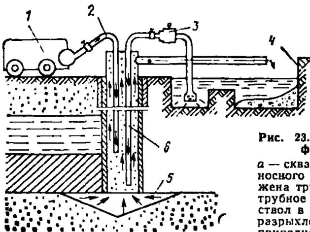
▲ Рис. 23. Этапы сооружения бесфильтровой скважины
