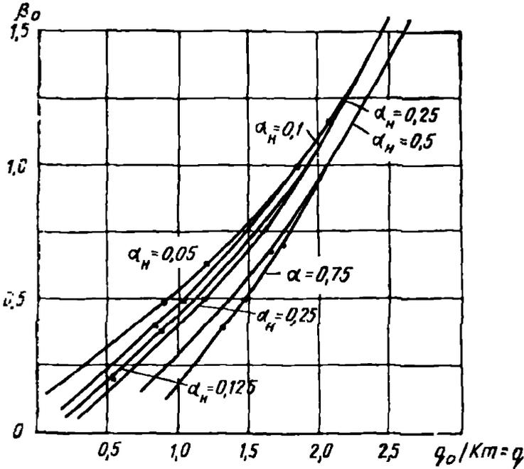
Рис. 13. График изменения приведенного удельного дебита  $q$ , бесфильтровой скважины от относительного радиуса водоприемной полости  $\beta_H$  для различного гидродинамического несовершенства полости по степени вскрытия пласта  $\alpha_H$ , построенный по результатам моделирования
