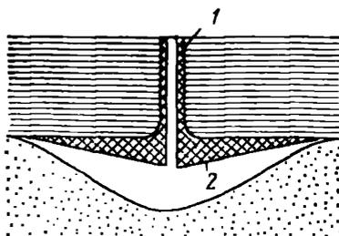
Рис. 30. Способ крепления кровли цементной подушкой
