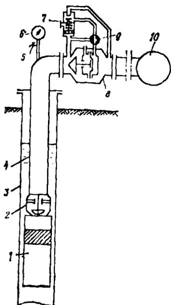
Рис. 36. Технологическая схема автоматического управления режимом пуска и остановки водозаборных скважин
