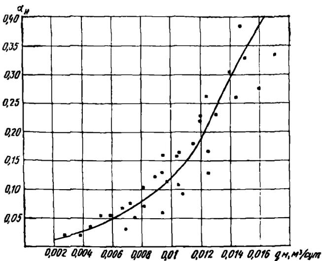
Рис. 12. График зависимости удельного дебита ( $q_{уд}$ ) бесфильтровой скважины на физической модели от гидродинамического несовершенства по степени вскрытия пласта ( $\alpha_H$ )
