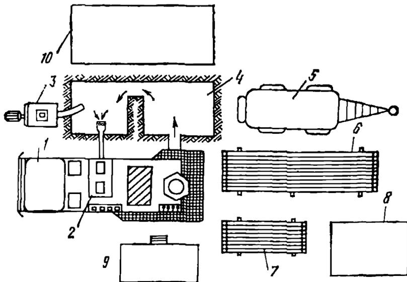
Рис. 22. Схема расположения оборудования на буровой площадке
