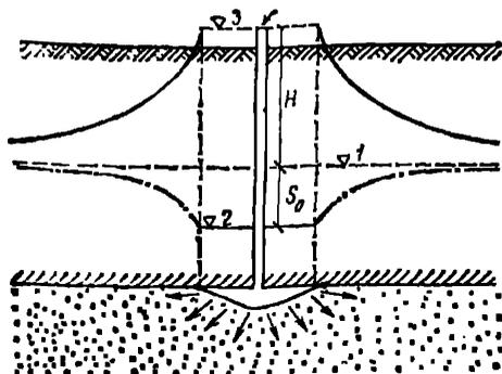
Рис. 17. Схема нагнетания в бесфильтровую скважину
