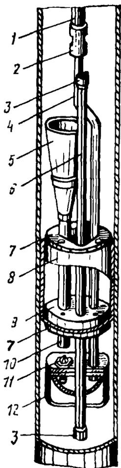
◀ Рис. 27. Погружной водоструйный насос ПВН-108
