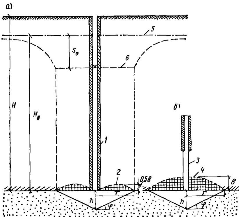
Рис. 18. Схема к расчету устойчивости кровли водопримной воронки
