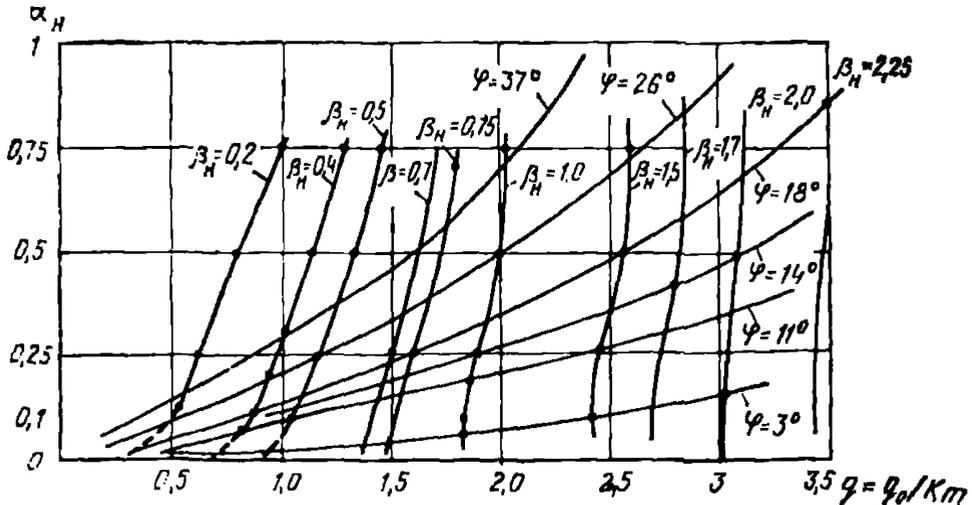
Рис. 14. График изменения приведенного удельного дебита  $q$  бесфильтровой скважины от гидродинамического несовершенства полости по степени вскрытия пласта  $\alpha_H$  при разных значениях относительного радиуса полости  $\beta_H$  и угла ее откоса  $\varphi$ , построенный по результатам моделирования
