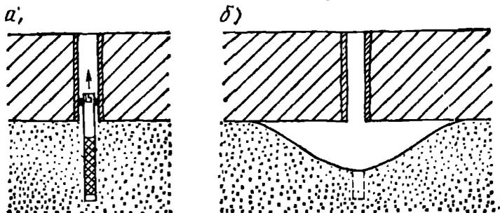
Рис. 31. Схема переоборудования скважины путем извлечения фильтра (а) и создания водоприсной воронки (б)
