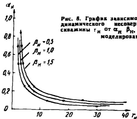
Рис. 8. График зависимости ширины зоны гидродинамического несовершенства бесфильтровой скважины  $r_n$  от  $\alpha_n \beta_n$ , построенный по данным моделирования на АВМ
