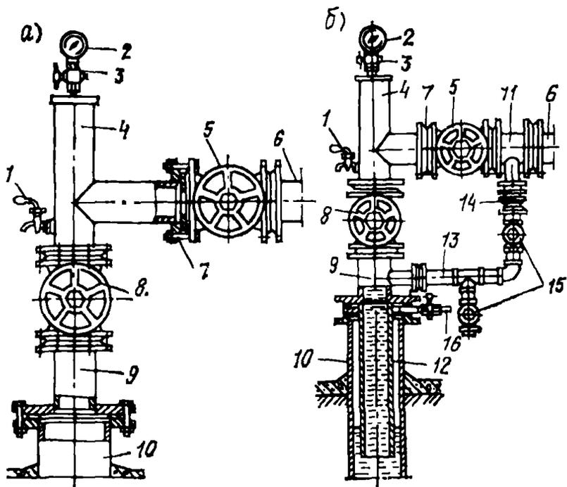
Рис. 34. Типы оголовков самозливающих скважин
