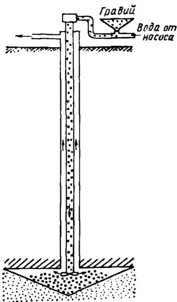
Рис. 29. Схема загрузки воронки гравием
