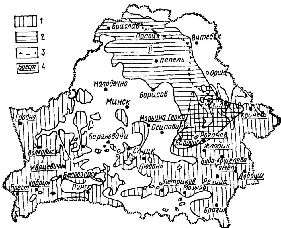
Рис. 4. Схема перспективных районов применения безфильтровых скважин в песках на территории БССР
