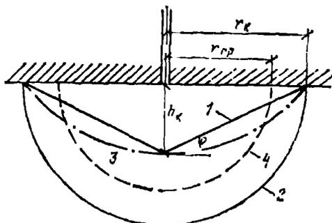
3.4. Опыт и модельные исследования показывают, что наиболее вероятной формой водоприемника является полость, похожая на сглаженный конус, с относительно пологим дном в центре, более крутыми откосами и выполаживающимися концевыми участками. Наибольшие дебиты наблюдаются в бесфильтровых скважинах с большим радиусом воронки и пологими углами откосов (табл. 2).
