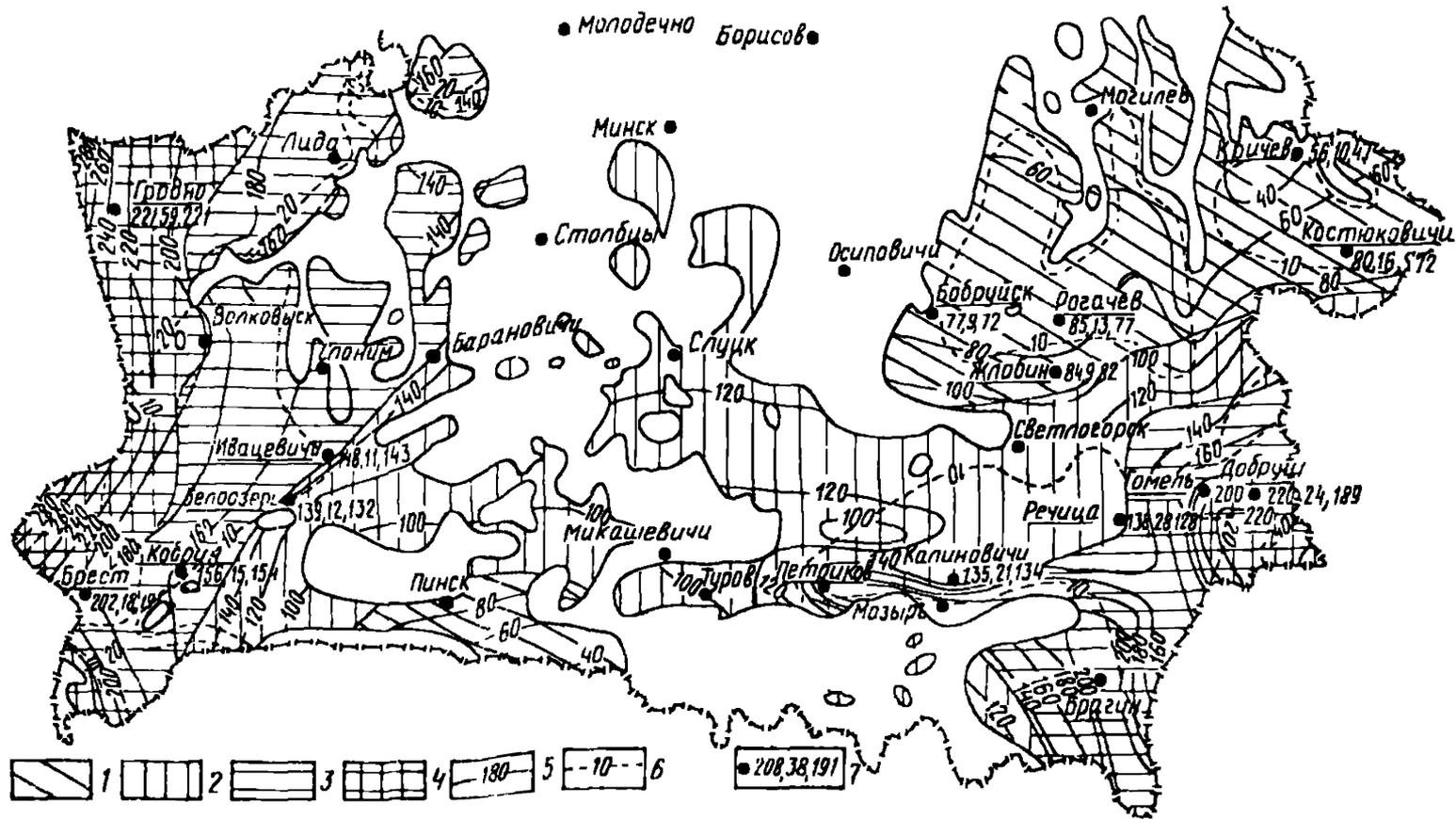
Рис. 6. Схематическая карта районирования альб-сеноманского водоносного горизонта территории БССР по условиям заложения бесфильтровых скважин
