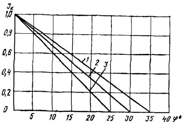
Рис. 19. График определения критического входного напорного градиента  $i_k$  при заданном угле откоса  $\varphi_0$  (по Г. Пивецки, 1968). Линии для угла внутреннего трения песков  $\varphi_T$
