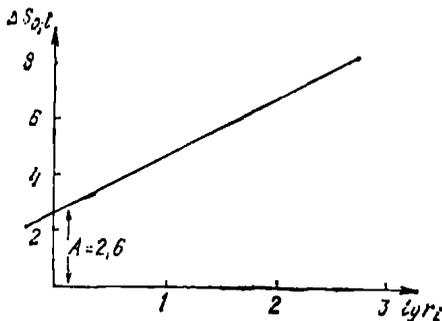
Рис. 21. График площадного прослеживания  $\Delta S_{0,i} \div \lg r_i$ , построенный по данным кустовой откачки из скважины 113
