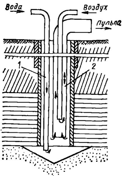
▲ Рис. 24. Общая схема сооружения бесфильтровой скважины с откачкой через обсадные трубы
