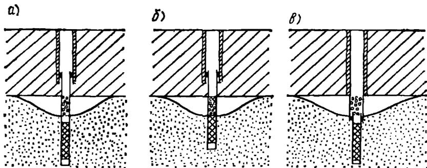
Рис. 32. Схема перехода на бесфильтровой отбор воды путем перфорации надфильтровой колонны (а), фильтра (б) или обсадной колонны (в) и образования воронки за трубами
