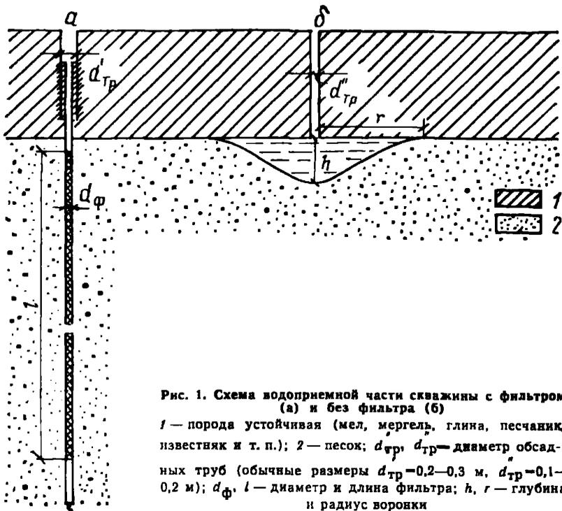
Рис. 1. Схема водоприемной части скважины с фильтром (а) и без фильтра (б)
