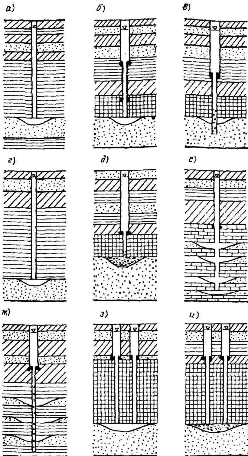
Рис. 2. Разновидности конструкций разведочных, наблюдательных, разведочно-эксплуатационных и эксплуатационных бесфильтровых скважин
