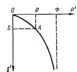
Рис. 3. Расчетная кривая сжатия нелинейнодеформируемого основания
