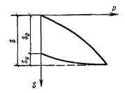
Рис. 2. Зависимость осадки давления при штамповых испытаниях
