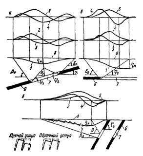
Рис. 1. Муньда сдвижения и эпюры деформаций земной поверхности
