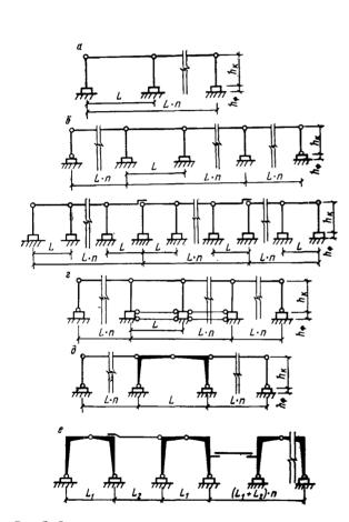
Рис. 5. Схемы поперечных рам одноэтажных каркасных зданий
