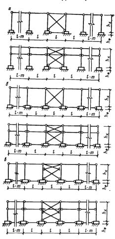
Рис. 6. Схемы продольных рам одноэтажных каркасныж зданий (бескрановых и с мостовыми кранами)
