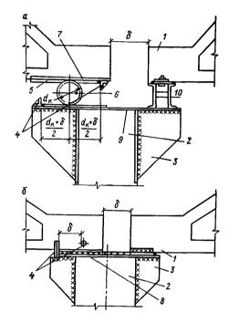
Рис. 7. Шарнирно-подвижные соединения
