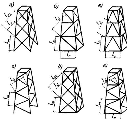
*а, б, е – с совмещенными в смежных гранях узлами; г, д – с не совмещенными в смежных гранях узлами; е – с частично совмещенными в смежных гранях узлами*
