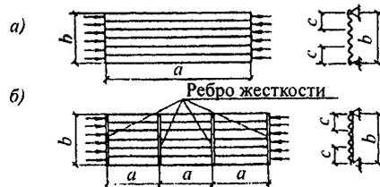
а – без поперечных ребер жесткости; б – с поперечными ребрами жесткости
