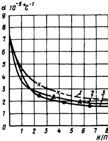
Рис. 27. Зависимость КЛТР полимер-раствора от вида и количества введенного наполнителя:
