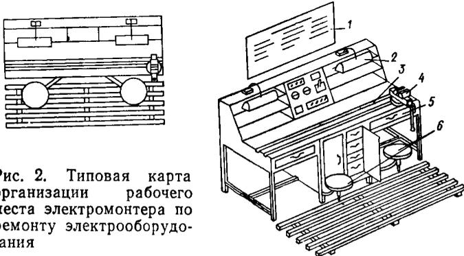
Рис. 2. Типовая карта организации рабочего места электромонтера по ремонту электрооборудования
