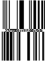
Рисунок 6 — Символ GS1 DataBar Двустрочный Всенаправленный, представляющий номер (01)00034567890125
