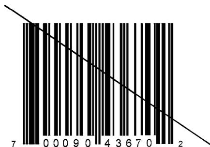
Рисунок Н.5 — Прецедент для символа с префиксом 07 (аналогичен для символа с префиксом 09), когда линия сканирования проходит через верхний край символа
