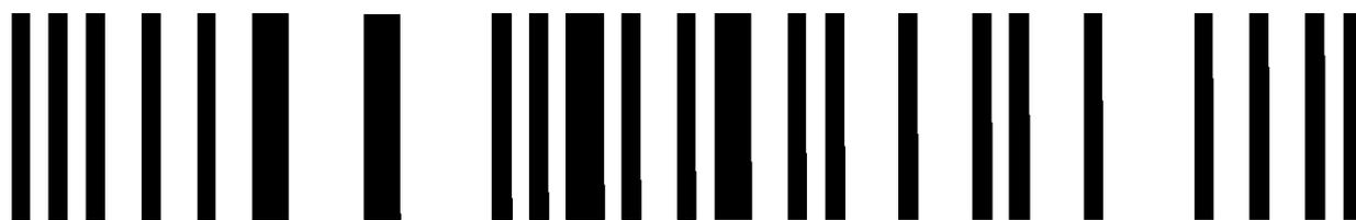
Рисунок F.2 — Пример символа GS1 DataBar Ограниченный
