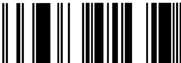
Рисунок F.3 — Пример символа GS1 DataBar Расширенный
