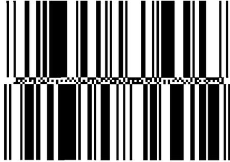
Рисунок 12 — Символ GS1 DataBar Расширенный Многострочный, представляющий номер (01)98898765432106(3202)012345(15)991231
