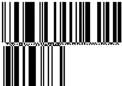
Рисунок 13 — Символ GS1 DataBar Расширенный Многострочный, представляющий номер (01)95012345678903(3103)000123
