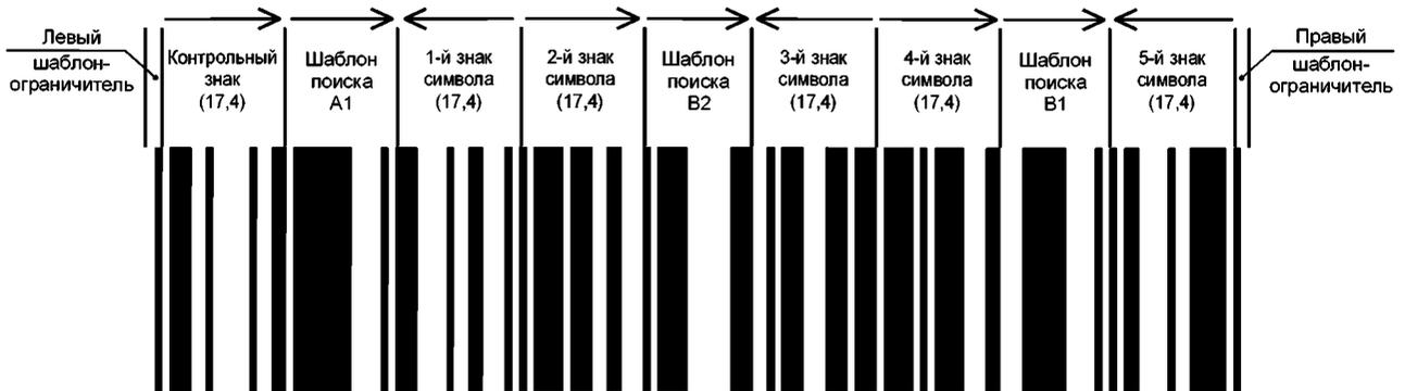
Рисунок 11 — Символ GS1 DataBar Расширенный, представляющий номер (01)90012345678908(3103)001750
