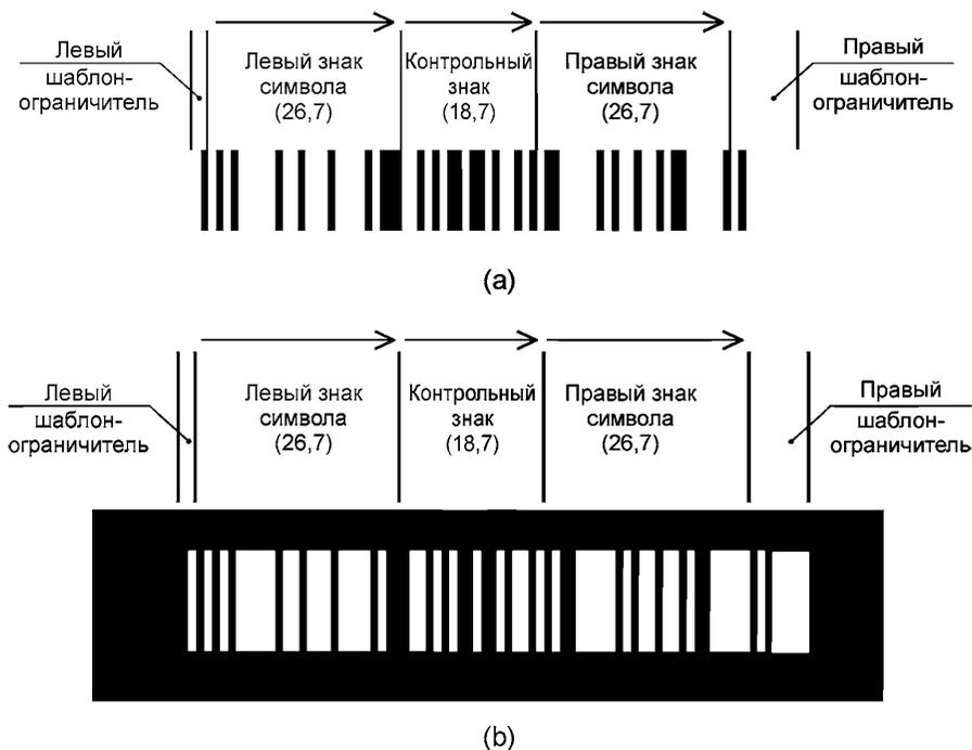
Рисунок 8 — Символ GS1 DataBar Ограниченный, представляющий номер (01)00312345678906 — (а), и этот же символ, напечатанный на темной подложке для демонстрации пробела шириной 5 модулей в правом шаблоне-ограничителе — (б)
