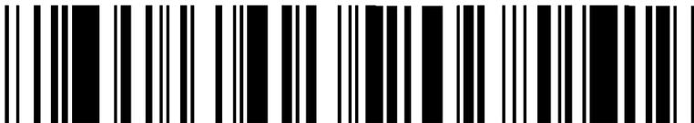
Рисунок 10 — Символ GS1 DataBar Расширенный, представляющий номер (01)98898765432106(3202)012345(15)991231
