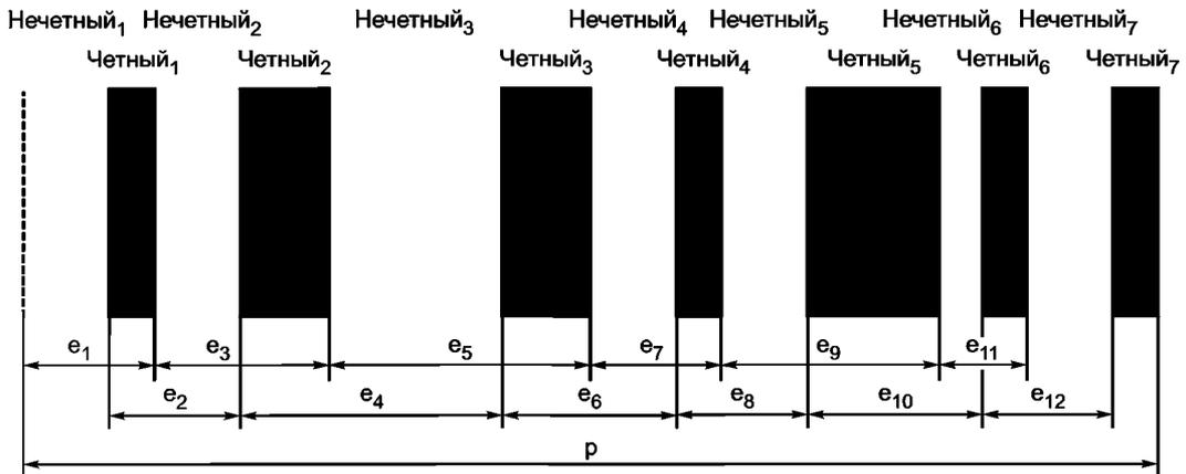
Рисунок 9 — Измеряемые параметры при декодировании
