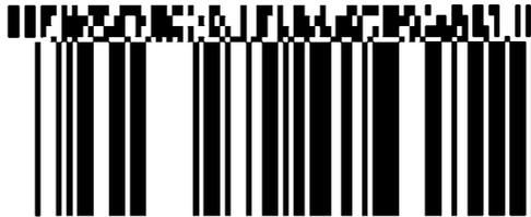
Рисунок F.1 — Пример символа GS1 Композитный
