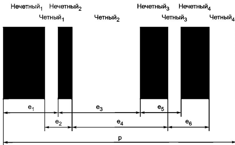
Рисунок 14 — Измеряемые параметры ширины при декодировании
