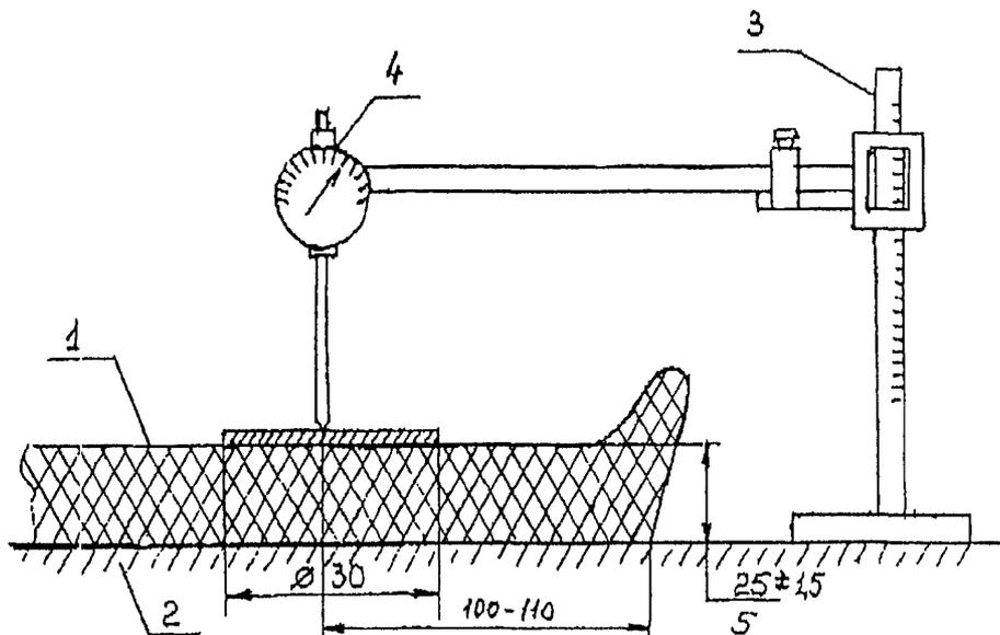
Рис.4 Схема измерения толщины прокладки для сиденья:
