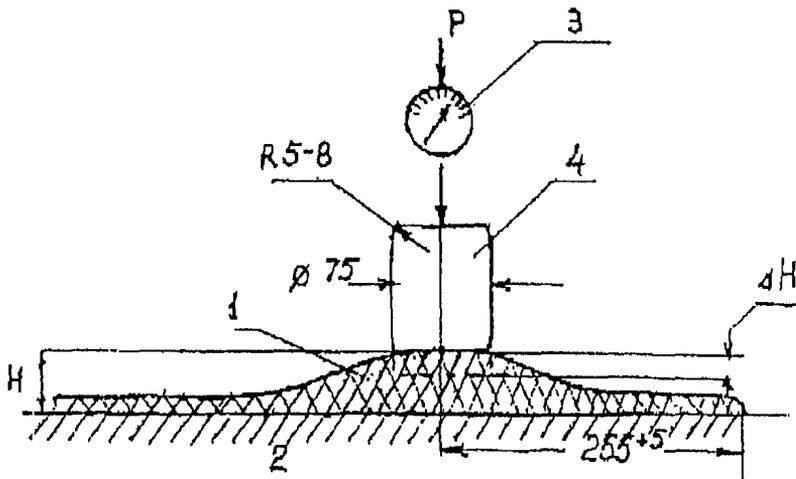
Рис.6 Форма пуансона и схема нагружения прокладки спинки при измерении действительного напряжения сжатия:
