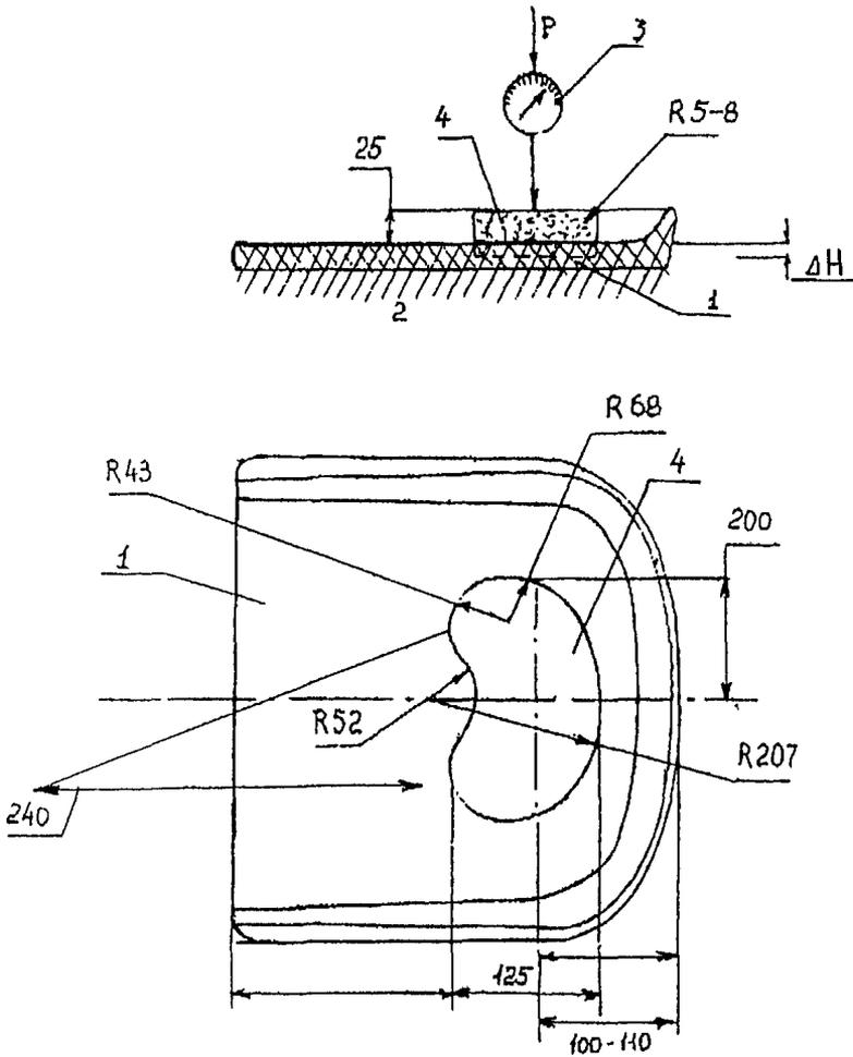
Рис.5 Форма пуансона и схема нагружения прокладки сиденья при измерении действительного напряжения сжатия:
