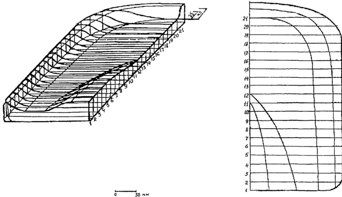
Рис.2 Формообразующие сечения профилированной прокладки сиденья
