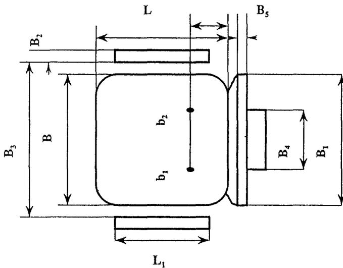
Рис.1 Основные конструктивные параметры кресла, проверяемые при сертификации на соответствие антропометрическим размерам
