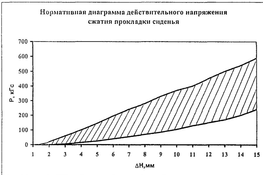
Рис 7 Нормативная диаграмма действительного напряжения сжатия прокладки сиденья.
