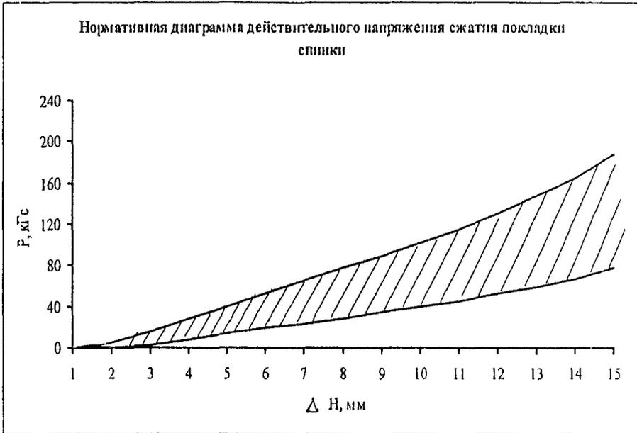
Рис.8. Нормативная диаграмма действительного напряжения сжатия прокладки спинки.
