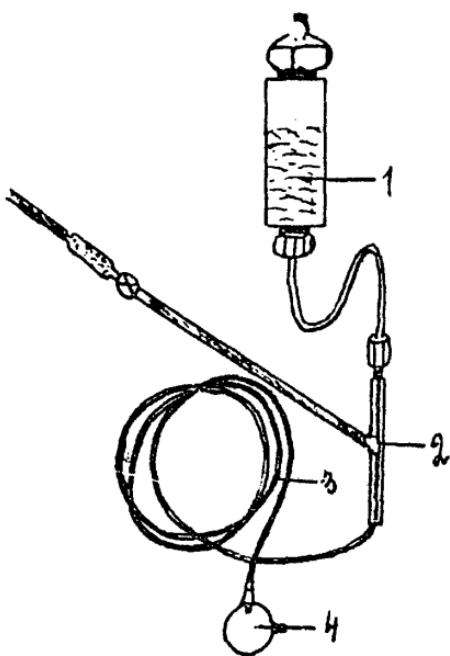
Рис. 2. Схема динамического диффузионного дозатора.
