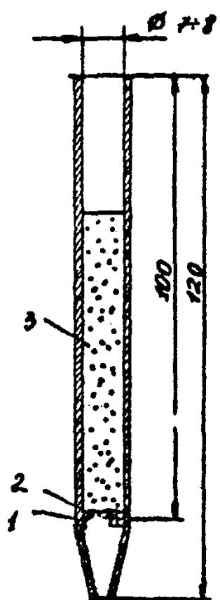
Рис.3. Концентрационная трубка
