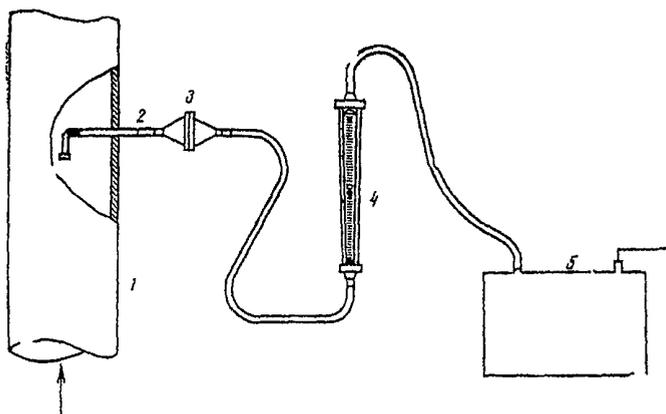
Рис. 18. Схема отбора проб пыли методом внешней фильтрации:
