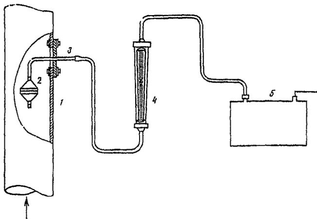
Рис. 19. Схема отбора проб пыли методом внутренней филь-
