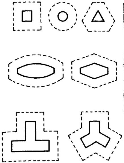
Рис. 1. Варианты планов монолитных стволов и зданий
