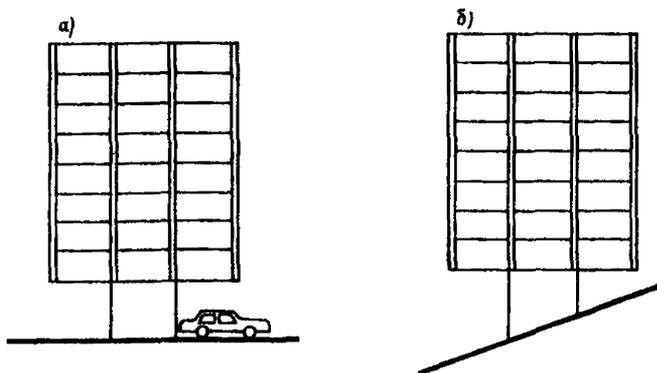
Рис. 4. Схемы зданий с незастроенным первым этажом
