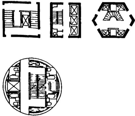
Рис. 2. Примеры планировочных решений монолитных ядер жесткости
