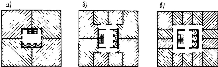
Рис. 3. Планировочные решения башенных зданий с монолитными ядрами жесткости (квартиры выделены штриховкой)
