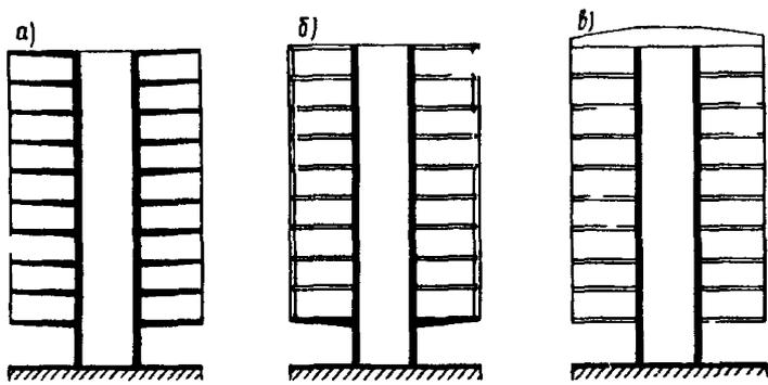
Рис. 5. Конструктивные решения здания с незастроенным первым этажом
